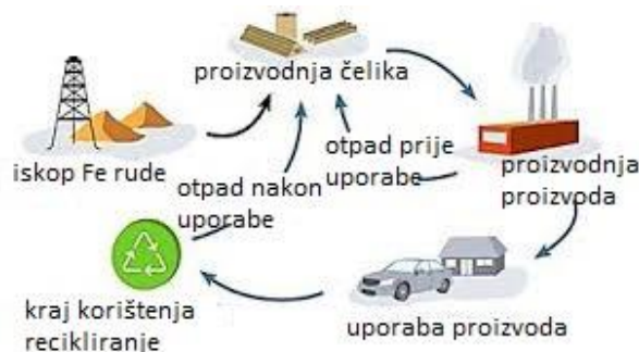
Slika 5. Proces recikliranja čelika [18]
