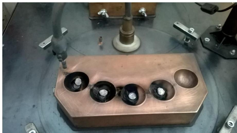
**Slika 15.** Taljenje uzoraka električnim lukom u bakrenom kalupu
