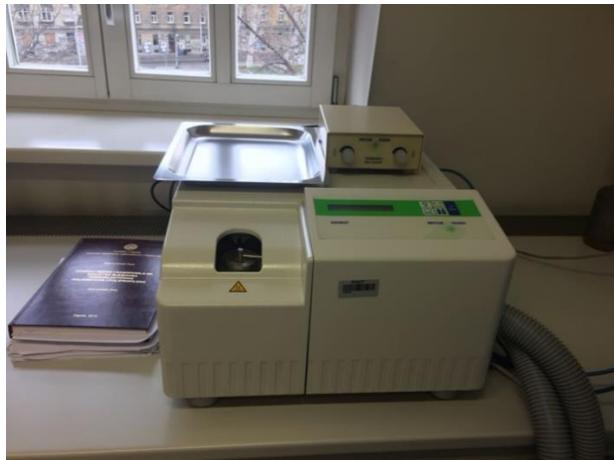
**Slika 20.** Diferencijalni pretražni kalorimetar *DSC Mettler Toledo 822e*
