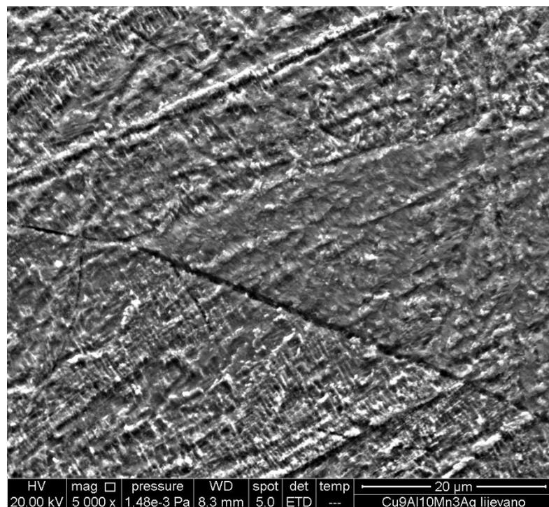
**Slika 27.** SEM mikrofotografija Cu-Al-Mn legure s 3 mas. % srebra u lijevanom stanju;
