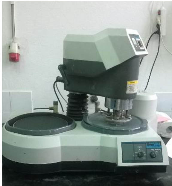
Slika 19. Uređaj za brušenje i poliranje Buehler „Phoenix beta“
