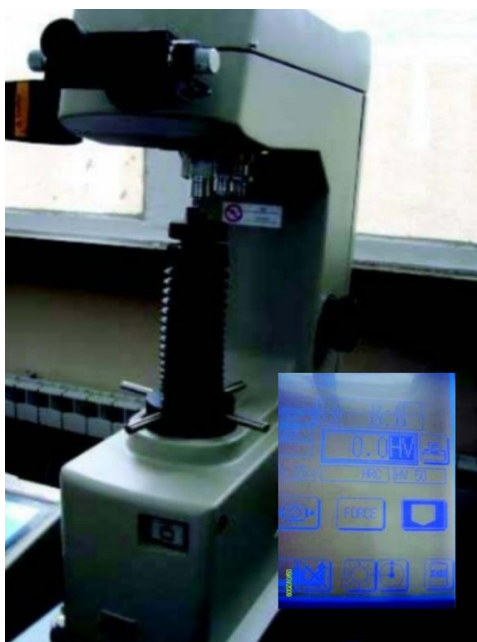
Slika 24. Vickersov tvrdomjer za mjerenje SMA legura [32]
