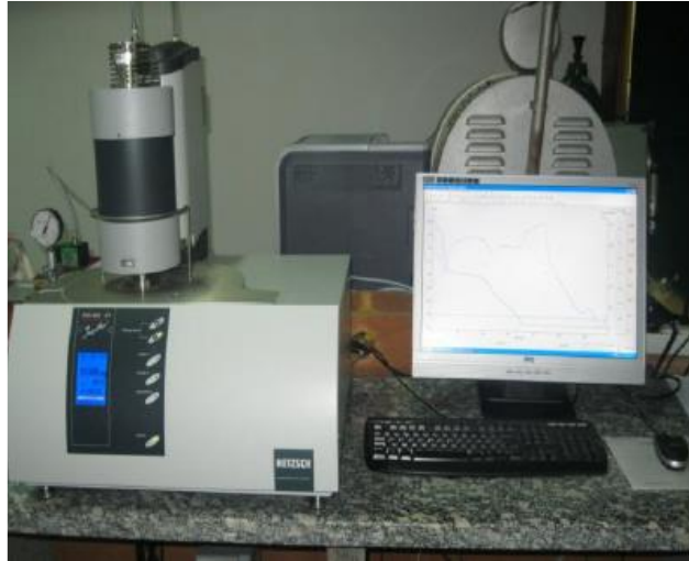
Slika 18. Simultani toplinski analizator STA DSC/TG [28]
