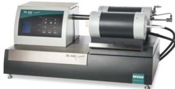
Slika 20. Dilatometar za praćenje faznih transformacija [29]
