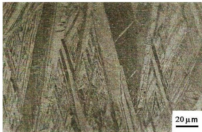
Slika 11. Martenzitna transformacija Cu<sub>81.2</sub>Al<sub>12.8</sub>.Ag<sub>6.0</sub>. legure [22]
