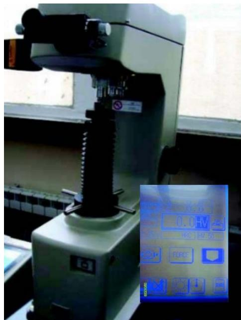
Slika 24. Vickersov tvrdomjer za mjerenje SMA legura [32]
