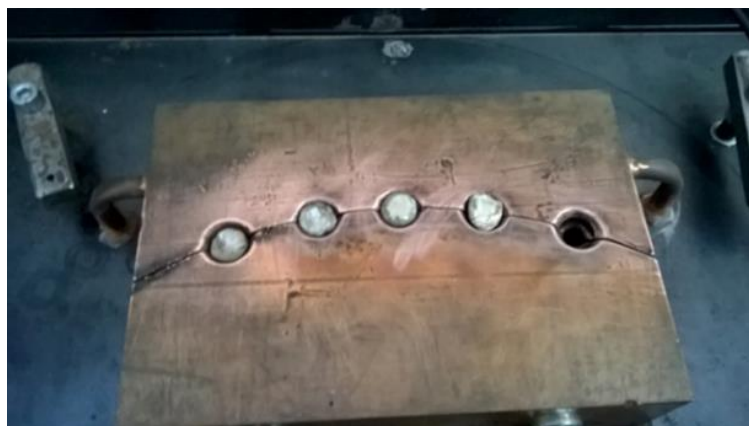
Slika 22. Kalup za lijevanje cilindričnih uzoraka
