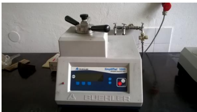
Slika 26. Uređaj za toplo ulijevanje Buehler Simplimet 1000
