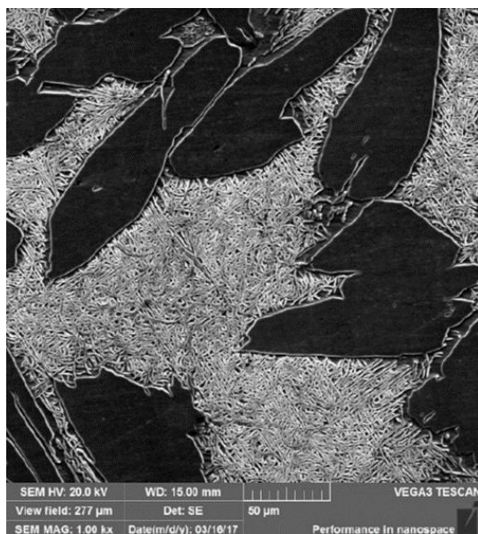
Slika 37. SEM mikrofotografija Cu-10Al-8Mn legure nakon homogenizacije i sporog hlađenja na zraku
