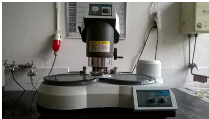
Slika 27. Uređaj za brušenje i poliranje Buehler „Phoenix Beta“
