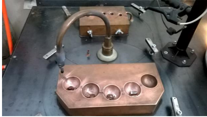
Slika 20 Odvagani čisti metali u bakrenom kalupu i volframova elektroda
