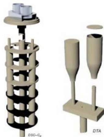
Slika 32. Nosač za DSC analizu [31]
