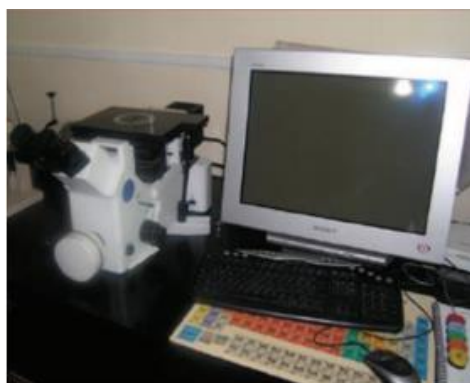
Slika 16. Metalografski mikroskop Olympus GX 51 s digitalnom kamerom DP 70
