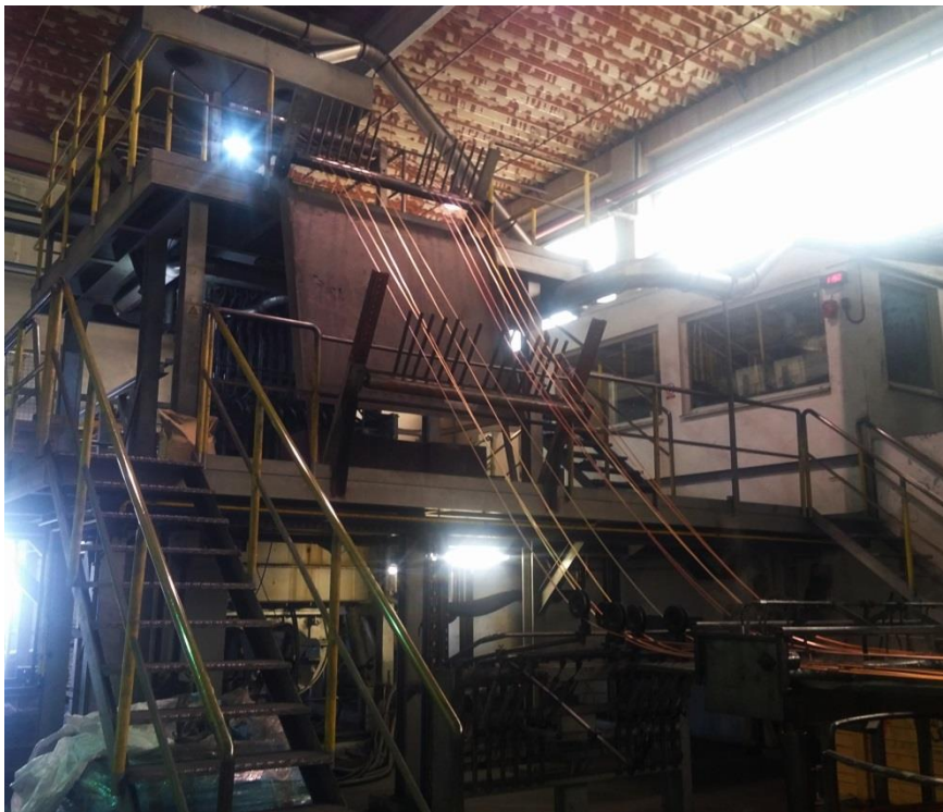
Slika 5. Povlačenje žice prema kolutovima
