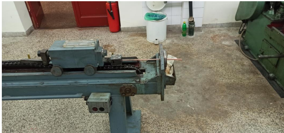
Slika 11. Provlačenje žice na vlačnoj klupi
