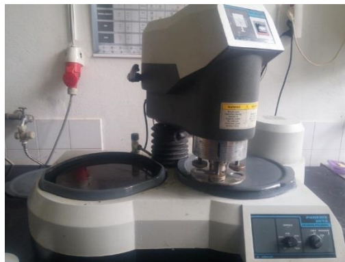
Slika 15. Uređaj za brušenje i poliranje Vektor LC Buehler Phoenix
