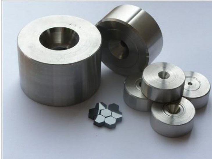
Slika 9. Matrice različitih promjera i oblika [15]
