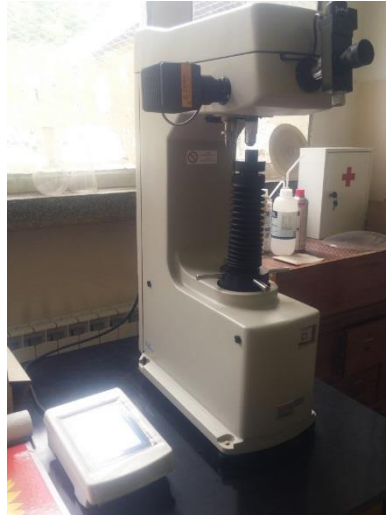
Slika 17. Uređaj za mjerenje tvrdoće metodom po Vickersu
