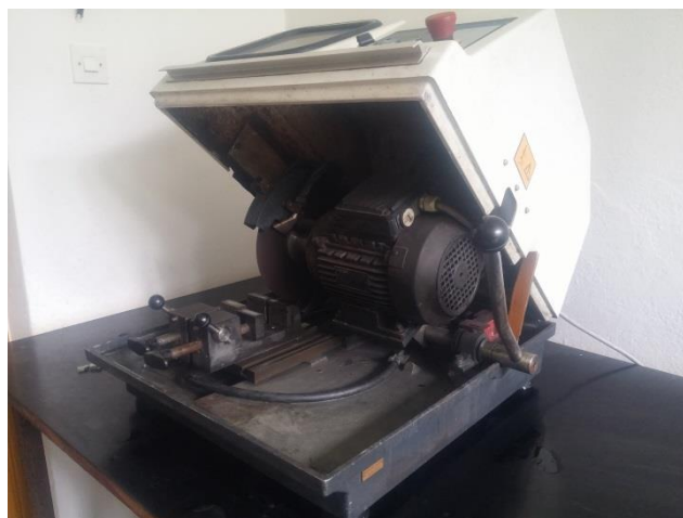
Slika 12. Uređaj za rezanje uzorka
