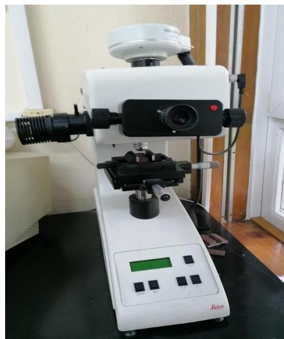
Slika 21. Fotografija uređaja za mjerjenje mikrotvrdoće Leica VHMT.
