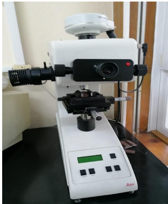
Slika 21. Fotografija uređaja za mjerenje mikrotvrdoće Leica VHMT.
