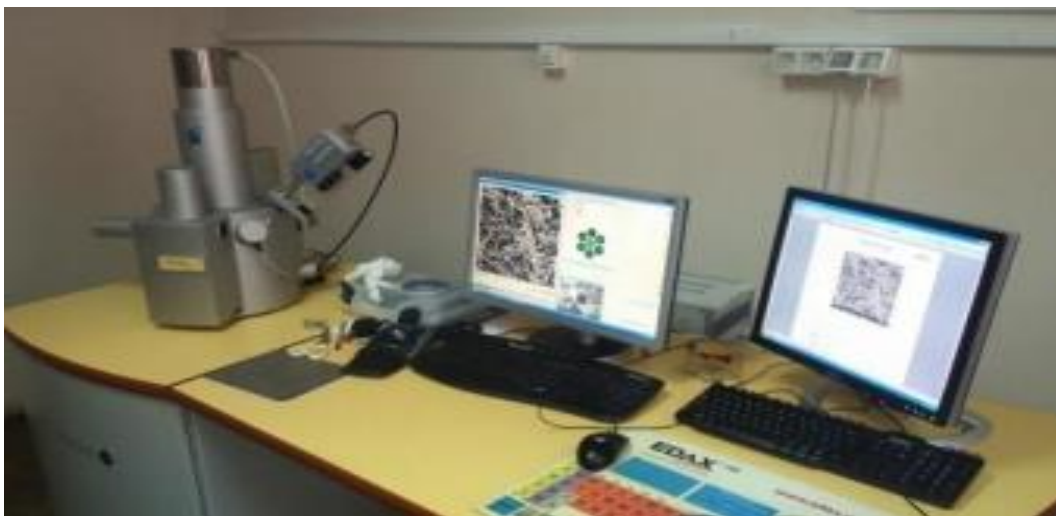
Slika 19. Fotografija pretražnog elektronskog mikroskopa Tescan Vega 5136MM opremljenog detektorom za energetske disperzijske rendgenske spektroskopije (EDS).
