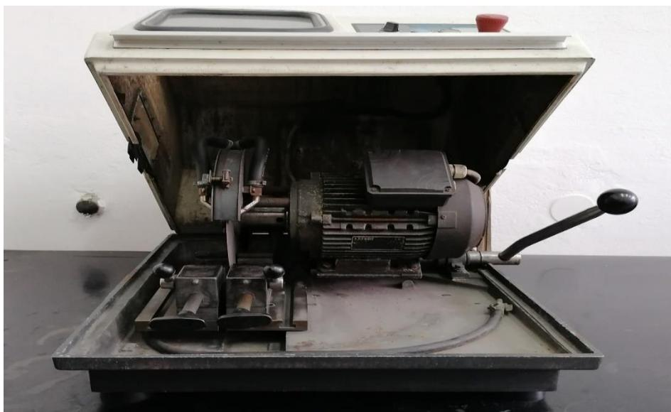
Slika 15. Fotografija uređaja za rezanje uzoraka Isomet Buehler.
