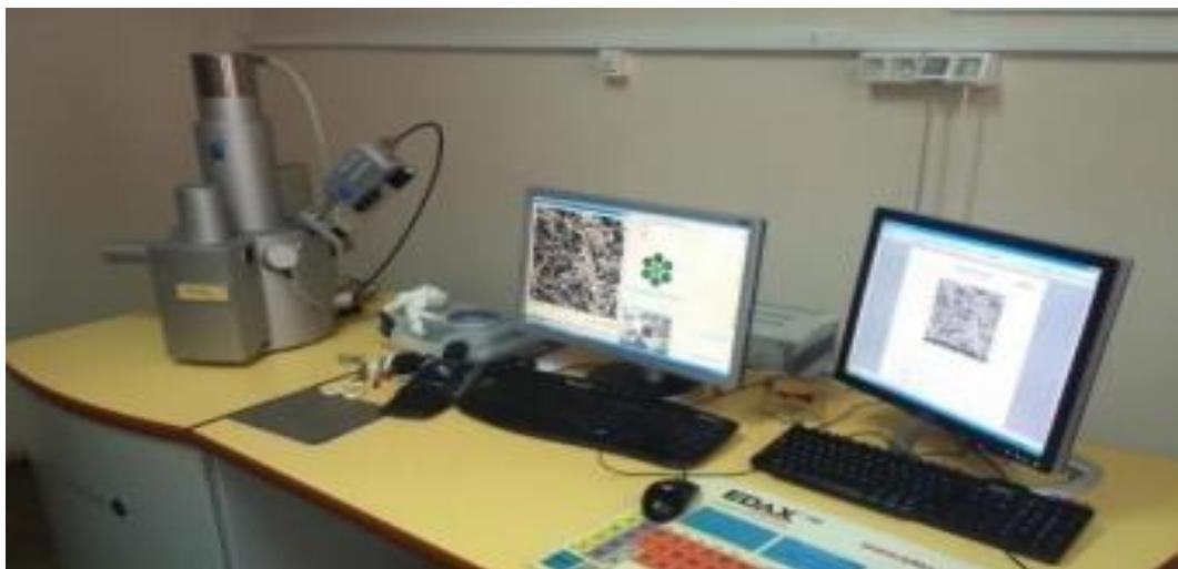
Slika 19. Fotografija pretražnog elektronskog mikroskopa Tescan Vega 5136MM opremljenog detektorom za energetsko disperzijsku rendgensku spektroskopiju (EDS).
