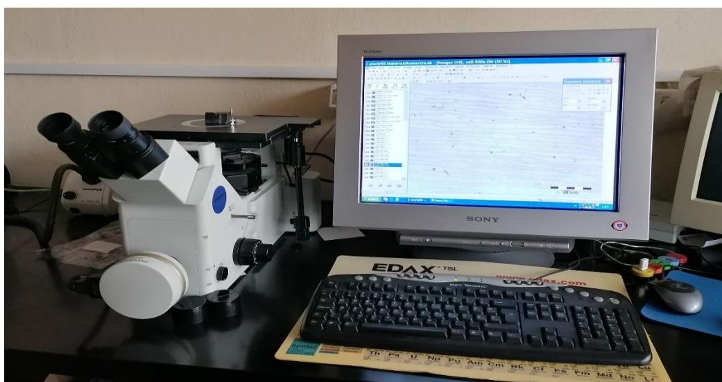
Slika 18. Fotografija optičkog mikroskopa Olympus GX 51.
