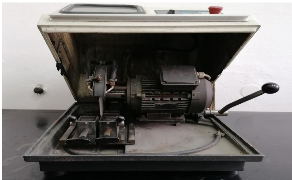
Slika 15. Fotografija uređaja za rezanje uzoraka Isomet Buehler.
