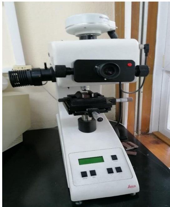
Slika 21. Fotografija uređaja za mjerenje mikrotvrdoće Leica VHMT.
