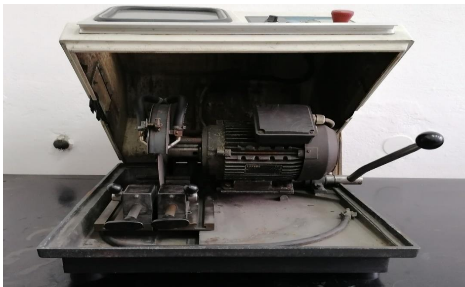
Slika 15. Fotografija uređaja za rezanje uzoraka Isomet Buehler.
