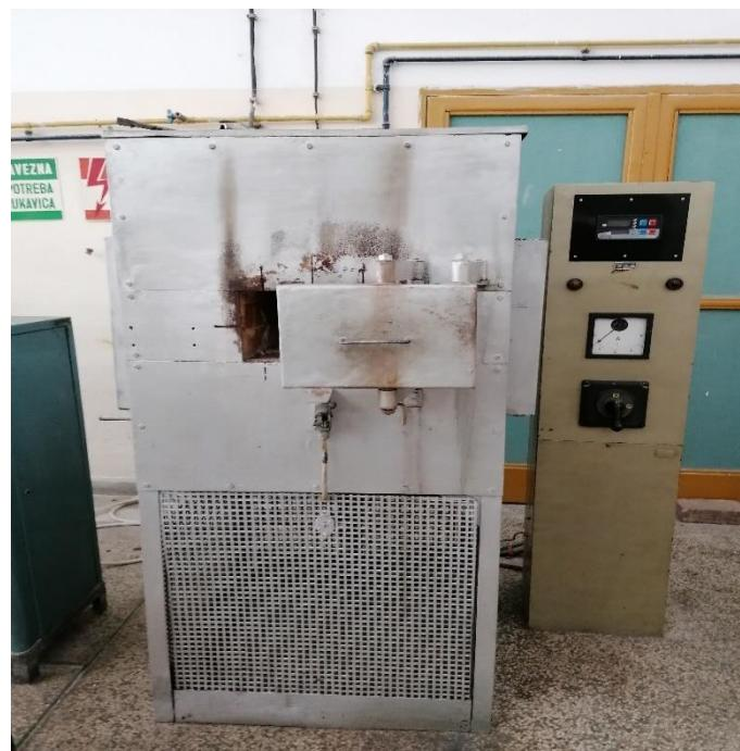
Slika 13. Fotografija elektrootporne komorne peći za žarenje.
