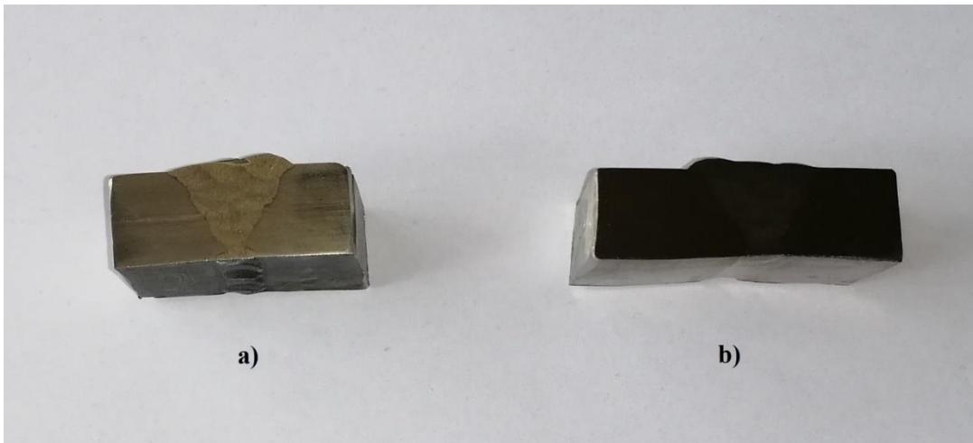
Slika 17. Fotografija uzorka nakon poliranja (a) i nagrizanja (b).
