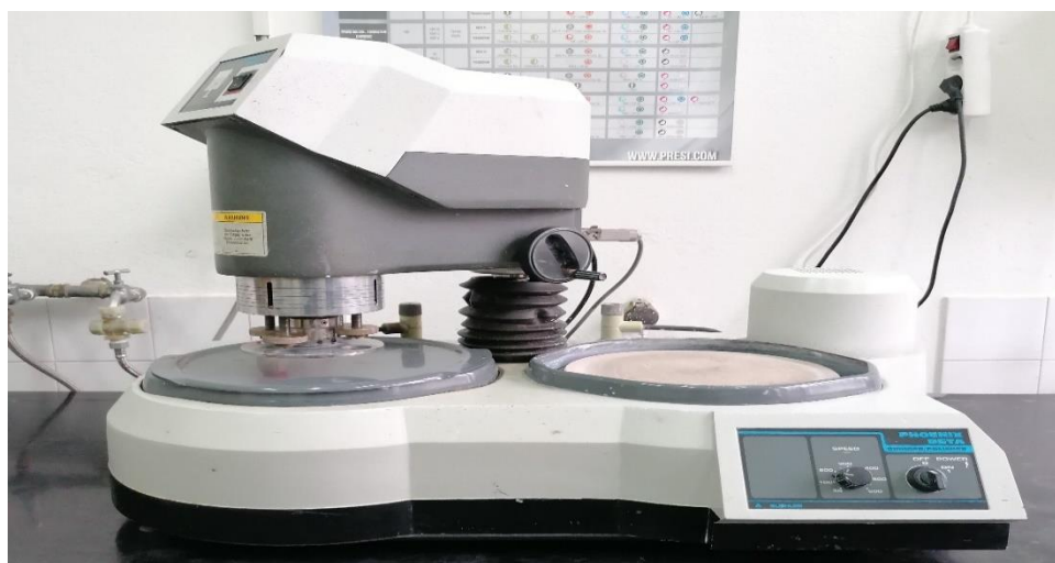
Slika 16. Fotografija uređaja za brušenje i poliranje Phoenix Beta Buehler.
