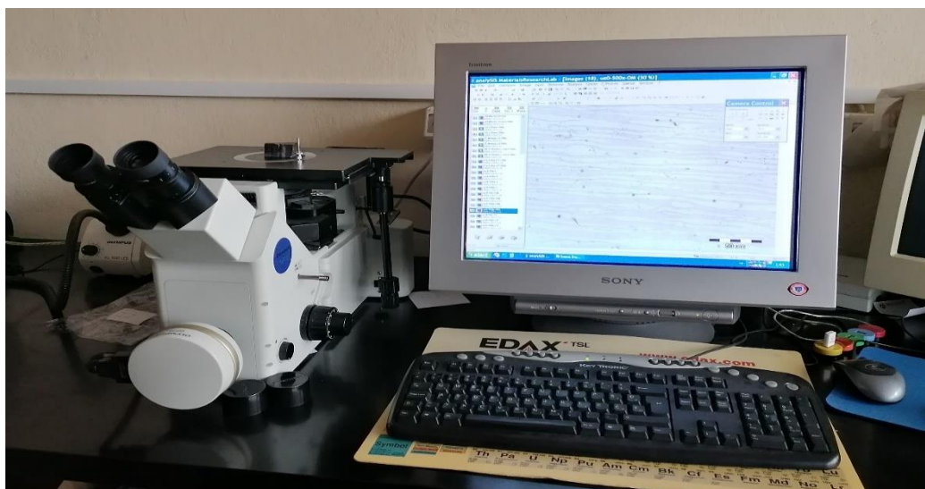
Slika 18. Fotografija optičkog mikroskopa Olympus GX 51.
