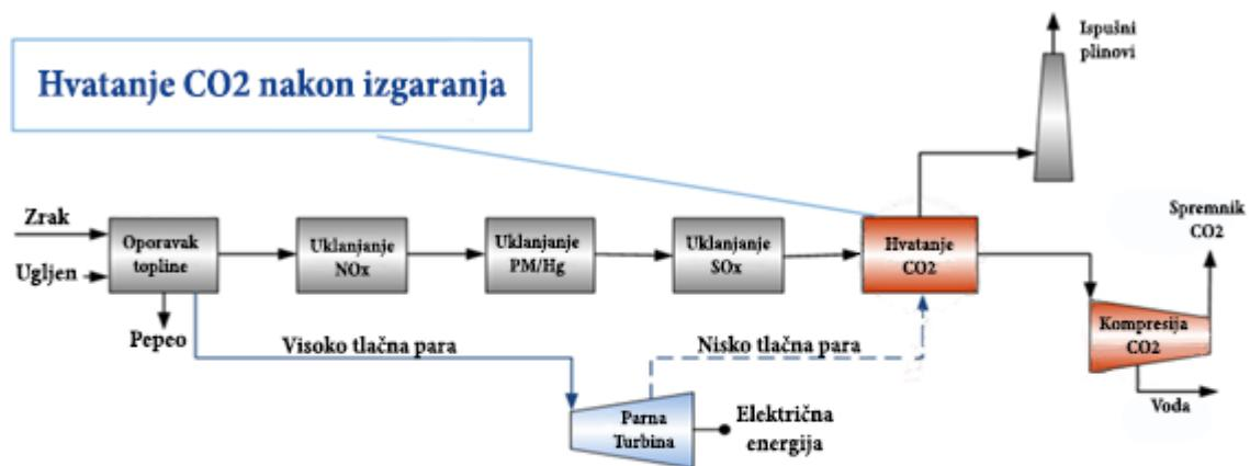
*Slika 12. Proces sakupljanja CO<sub>2</sub> nakon sagorijevanja [23]*
