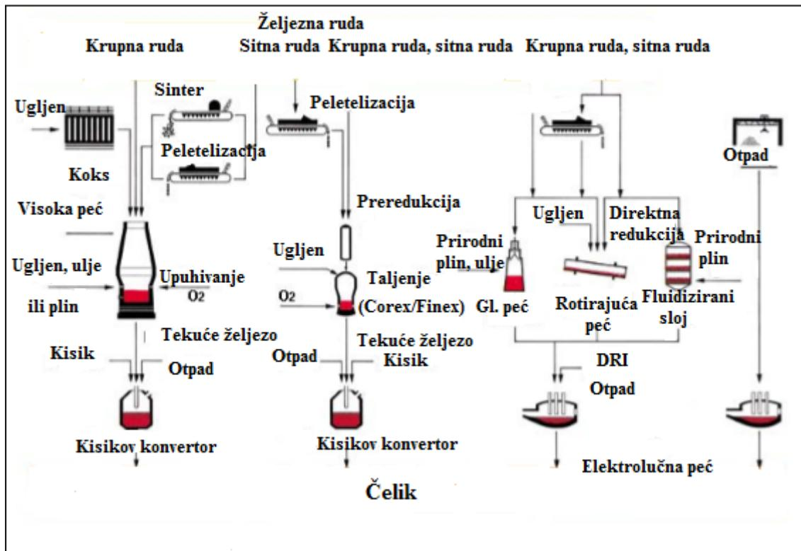
Slika 4. Postupci proizvodnje čelika u integralnim željezarama [14]
