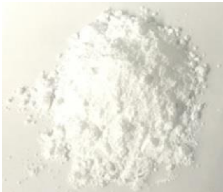
Slika 5. Nanočestice \text{TiO}_2 u praškastom obliku [22]
