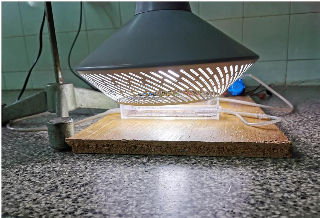
Slika 16. UV lampa iznad reaktora
