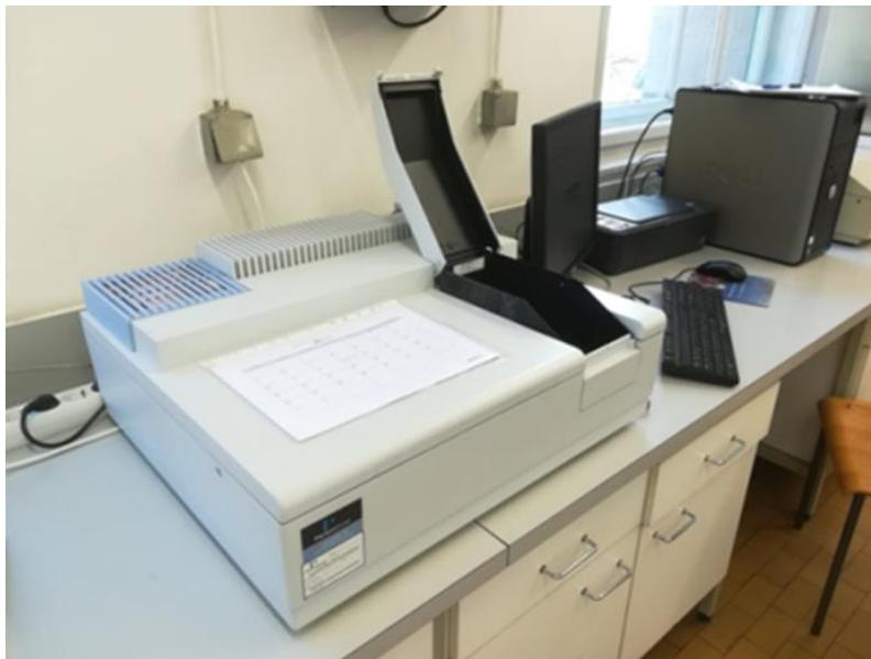
**Slika 13.** UV/VIS spektrofotometar u laboratoriju na FKIT-u.
