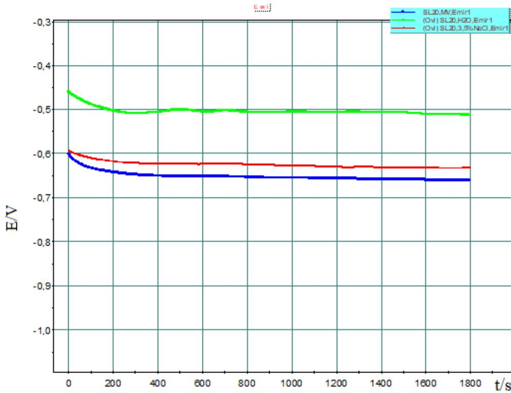
Slika 44. Ovisnost potencijala kod otvorenog strujnog kruga o vremenu za sivi lijev označke SL20 u mediju obične vode, umjetne morske vode i 3,5% NaCl
