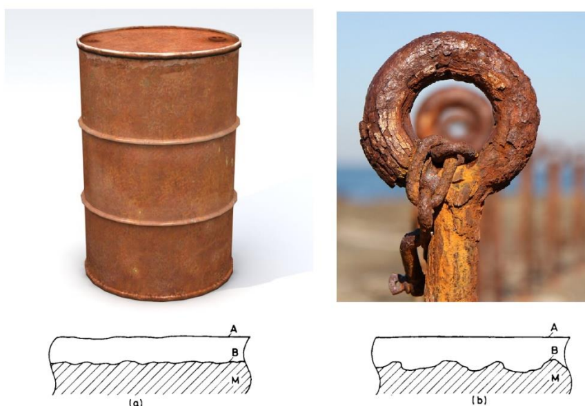
Slika 9. Opća korozija željeza [12]
