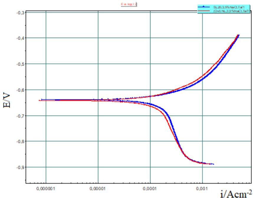
Slika 62. Polarizacijske krivulje dobivene za ispitane ljevove u mediju 3,5% NaCl
