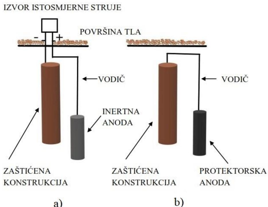
Slika 20. Katodna zaštita metala [6]
