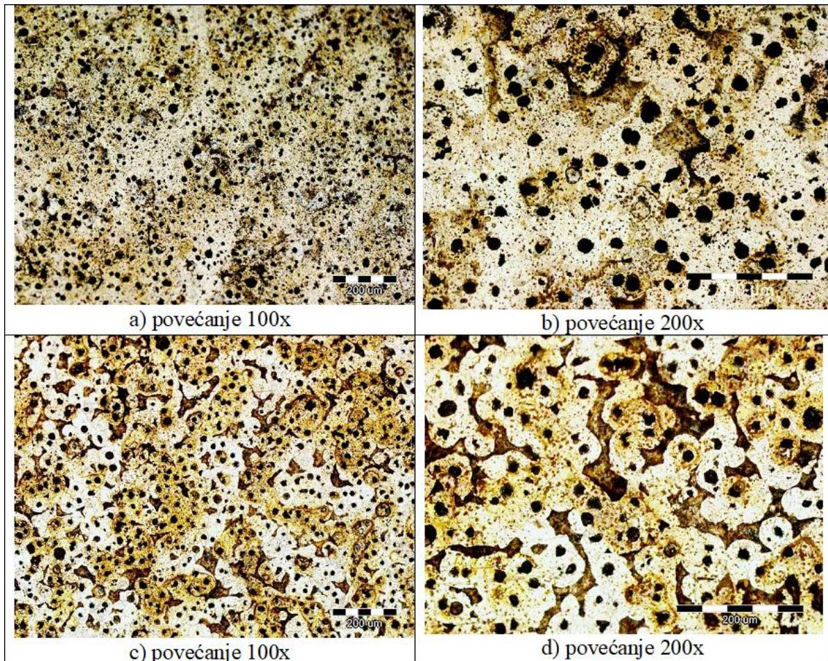
Slika 66. Mikrostruktura nodularnog lijeva NL: a) i b) nakon elektrokemijskih mjerena u mediju obične vode, c) i d) nakon elektrokemijskih mjerena u mediju umjetne morske vode
