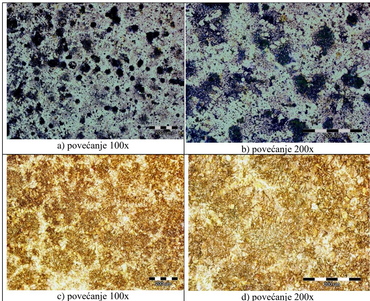
Slika 65. Mikrostruktura sivog lijeva oznake SL23: a) i b) nakon elektrokemijskih mjerena u mediju obične vode, c) i d) nakon elektrokemijskih mjerena u mediju umjetne morske vode
