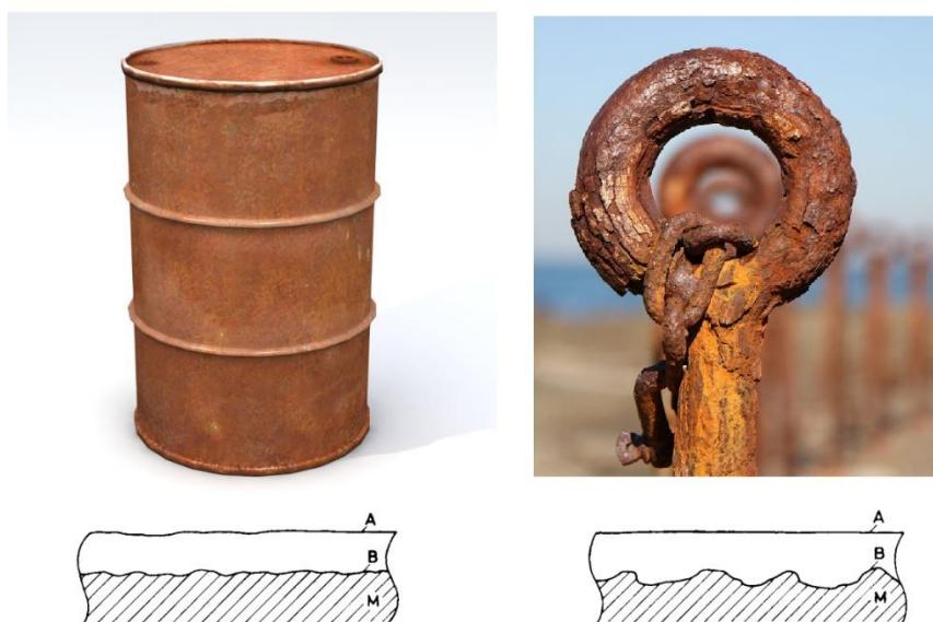
Slika 9. Opća korozija željeza [12]
