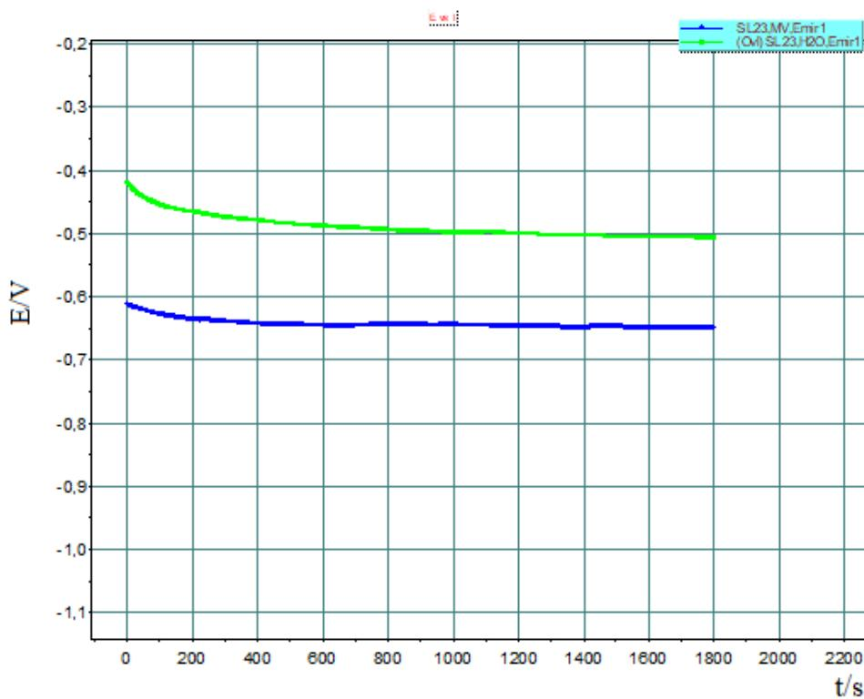
Slika 45. Ovisnost potencijala kod otvorenog strujnog kruga o vremenu za sivi lijev označke SL23 u mediju obične vode i umjetne morske vode
