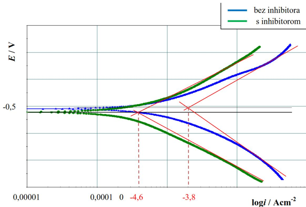
Slika 24. Krivulja polarizacije niskougljičnog čelika u agresivnom mediju sumporne kiseline bez dodatka inhibitora i s dodatkom inhibitora tiouree [6]
