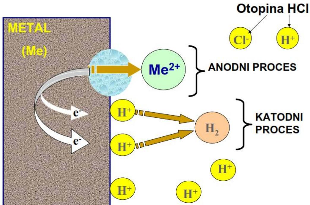
Slika 6. Elektrokemijska korozija metala nastala formiranjem mikrogalvanskog članka [10]
