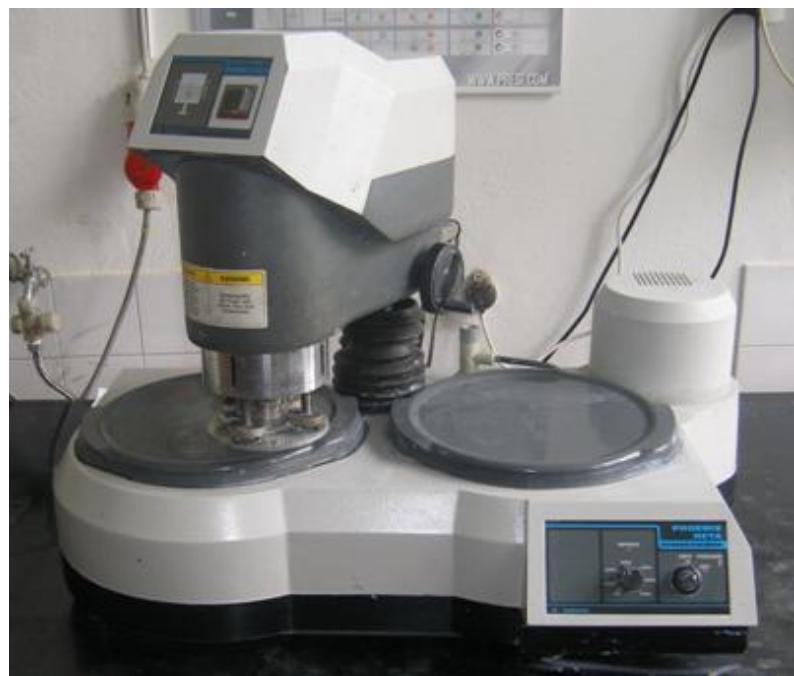
Slika 42. Uređaj za brušenje i poliranje PHENIXBETA GRINDING/POLISHER [38]
