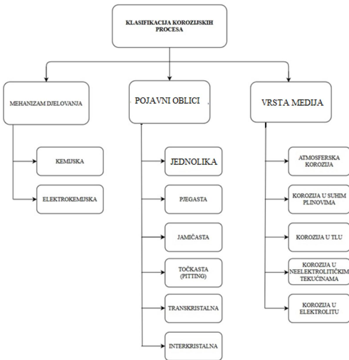
Slika 4. Klasifikacija korozijskih procesa [2,8]
