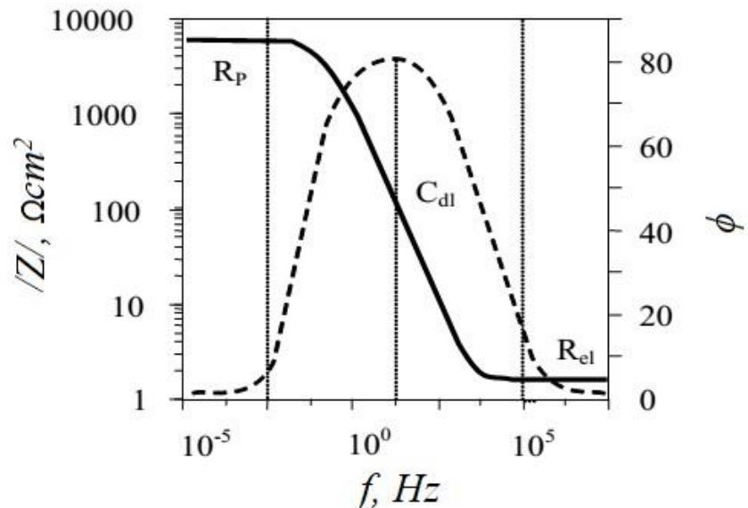
Slika 26. Bodeov dijagram jednostavnog elektrokemijskog sustava [8]
