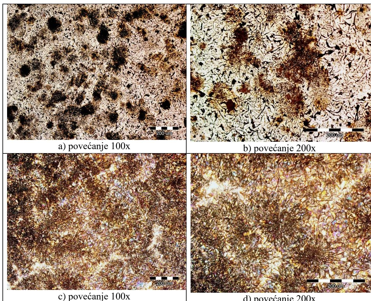
Slika 64. Mikrostruktura sivog lijeva označke SL20: a) i b) nakon elektrokemijskih mjerena u mediju obične vode, c) i d) nakon elektrokemijskih mjerena u mediju umjetne morske vode
