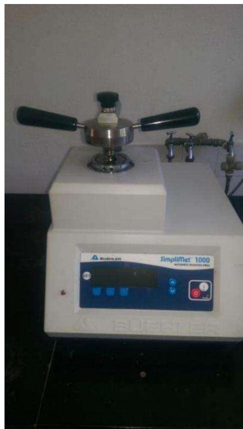
Slika 41. Uređaj za ulaganje uzoraka vrućim prešanjem SimpliMet® 1000 [38]
