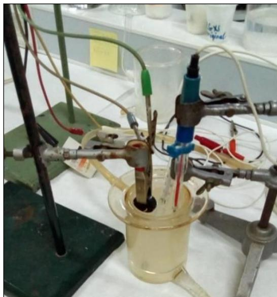
Slika 38. Troelektrodna staklena čelija za elektrokemijska mjerena
