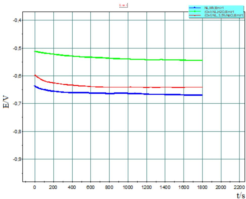
Slika 46. Ovisnost potencijala kod otvorenog strujnog kruga o vremenu za nodularni lijev označeni NL u mediju obične vode, umjetne morske vode i 3,5% NaCl
