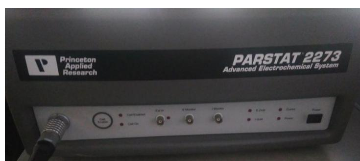
Slika 39. Potenciostat/galvanostat Parstat 2273 [38]
