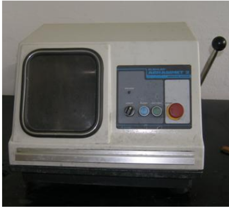
Slika 40. Rezalica Bühler ABRASIMET 2 [38]
