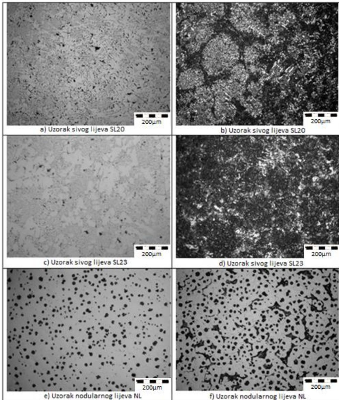
Slika 63. Mikrostruktura ispitanih lijevova: a) c) e) prije nagrivanja, b) d) f) nakon nagrivanja u nitalu (povećanje 100x)
