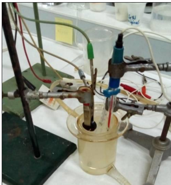
Slika 38. Troelektrodna staklena ćelija za elektrokemijska mjerenja
