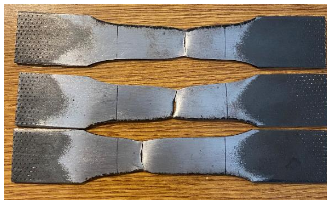
Slika 41. Uzorci nakon statičkog vlačnog ispitivanja kut 45^\circ
