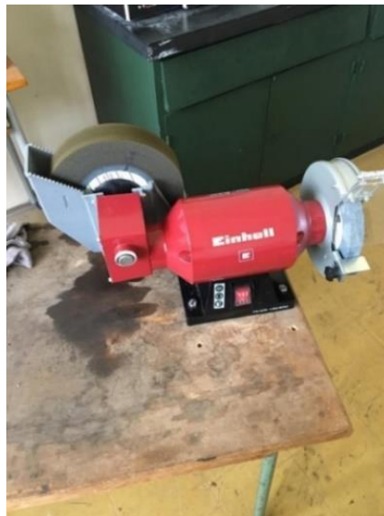
Slika 26. Brusilica Einhell TC-WD 150/200
