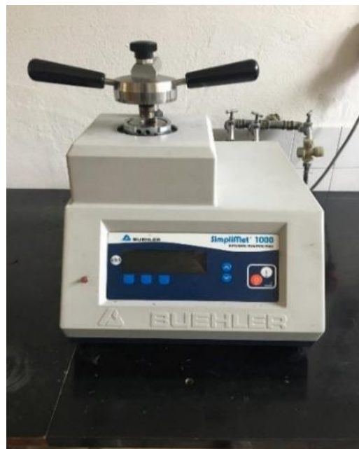
Slika 35. Uređaj SimpliMet 1000 za ulaganje uzoraka toplim prešanjem
