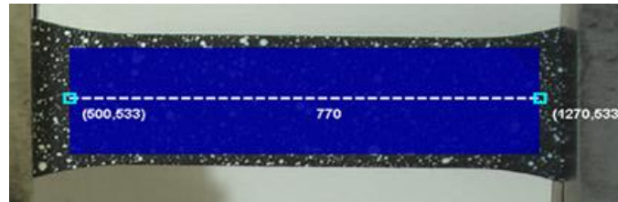
Slika 63. Linijska analiza promjene iznosa deformacije duž ispitnog uzorka
