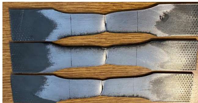
Slika 40. Uzorci nakon statičkog vlačnog ispitivanja kut 90^\circ
