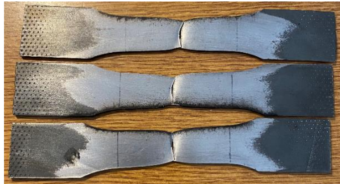
Slika 39. Uzorci nakon statičkog vlačnog ispitivanja kut 0^\circ
