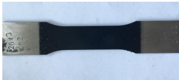
Slika 30. Uzorak nakon nanošenja crnog mat premaza
