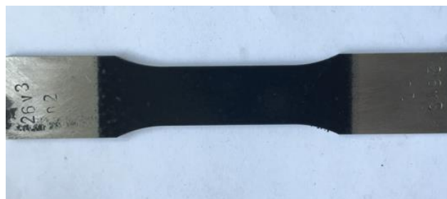
Slika 30. Uzorak nakon nanošenja crnog mat premaza
