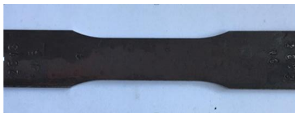
Slika 23. Uzorak koji se koristi za statički vlačni pokus obrađen na CNC stroju
