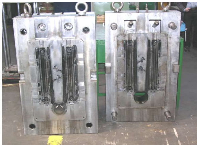
Slika 6. Trajni kalup za visokotlačni lijev
