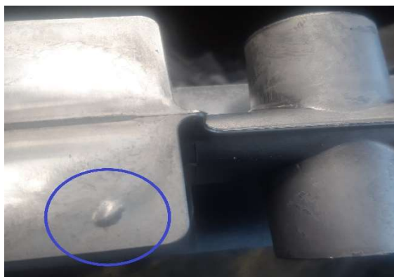
Slika 12. Plinski mjehuri (plikovi)
