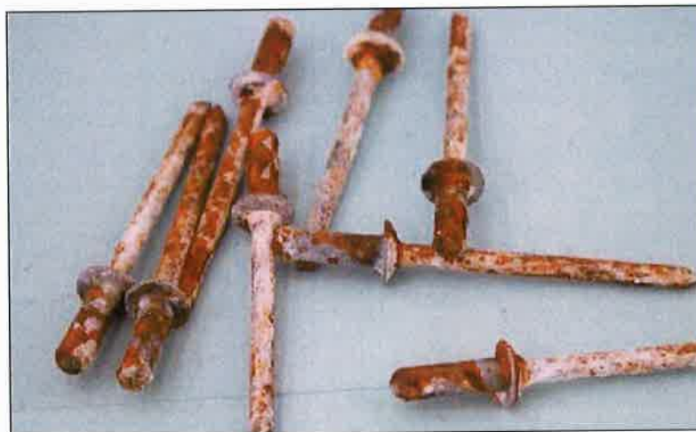
Slika 2. Kemijska korozija blok zakovica i zakivnih matica [6]
