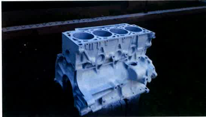
Slika 20. Blok motora zaštićen temeljnom bojom
