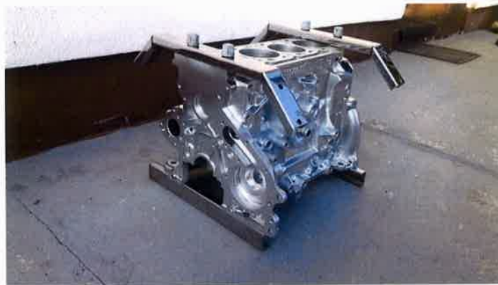
Slika 21. Blok motora zaštićen od korozije kromovom prevlakom
