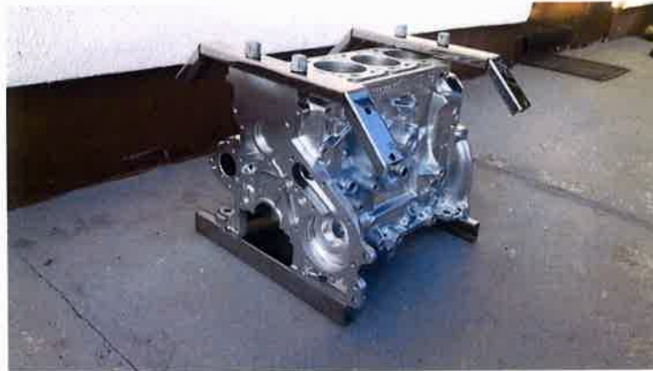
Slika 21. Blok motora zaštićen od korozije kromovom prevlakom
