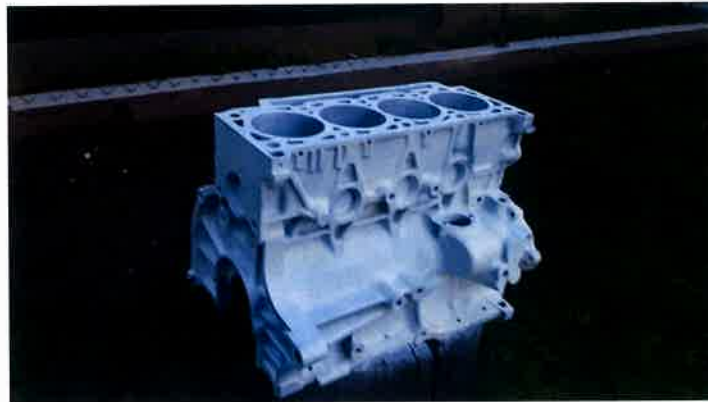
Slika 20. Blok motora zaštićen temeljnom bojom
