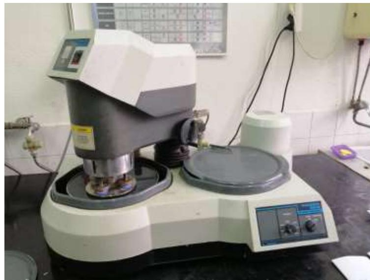
Slika 7. Uredaj za brušenje i poliranje uzorka Buehler „Phoenix Beta“
