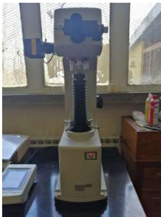
Slika 9. Tvrdomjer Mitutoyo Hardness Testing Machine HV,
