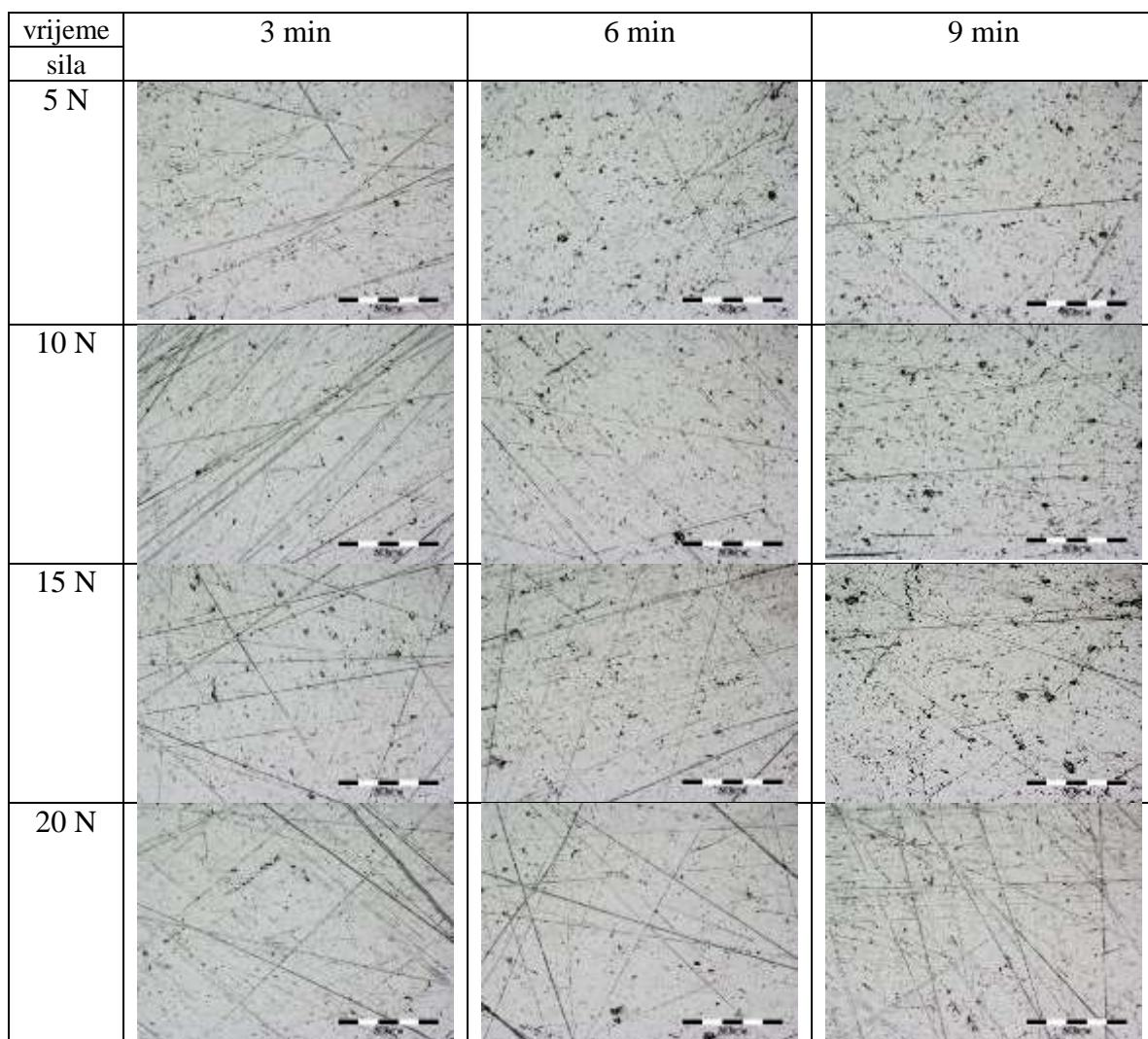
Slika 10. Stanje površine uzorka nakon brušenja primjenom različitih opterećenja u različitim vremenima
