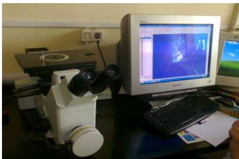
Slika 8. Svjetlosni mikroskop Olympus GX 51
