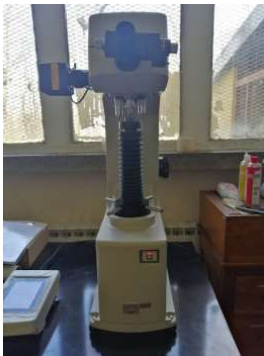
Slika 9. Tvrdomjer Mitutoyo Hardness Testing Machine HV, Model No. 810-165D
