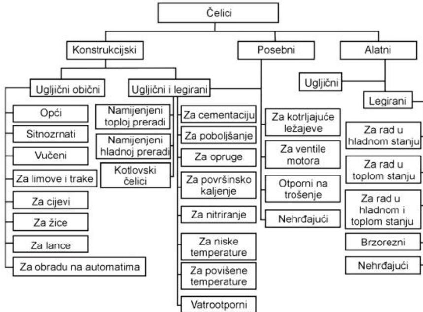
Slika 10. Podjela čelika prema namjeni [21]
