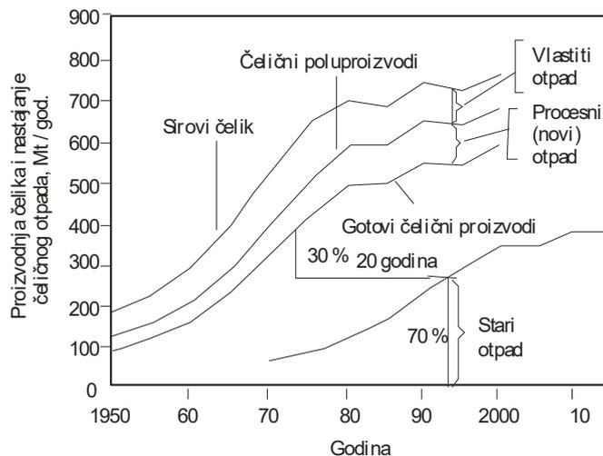
Slika 13. Odnos proizvodnje čelika i potrošnje čelika te nastajanja čeličnog otpada u svijetu [10]
