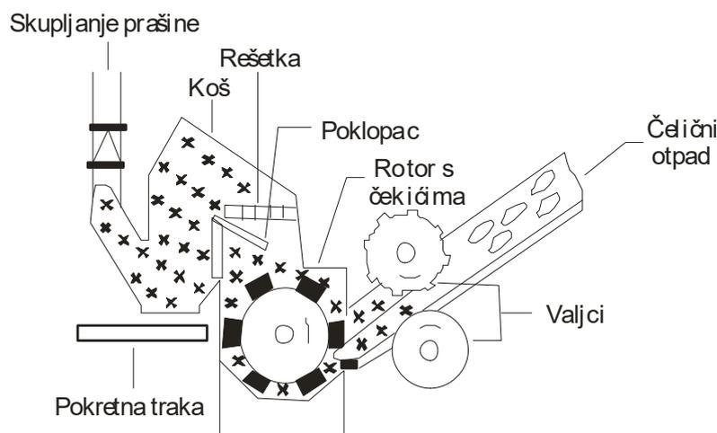
Slika 14. Shematski prikaz "šreder" postrojenja [32]
