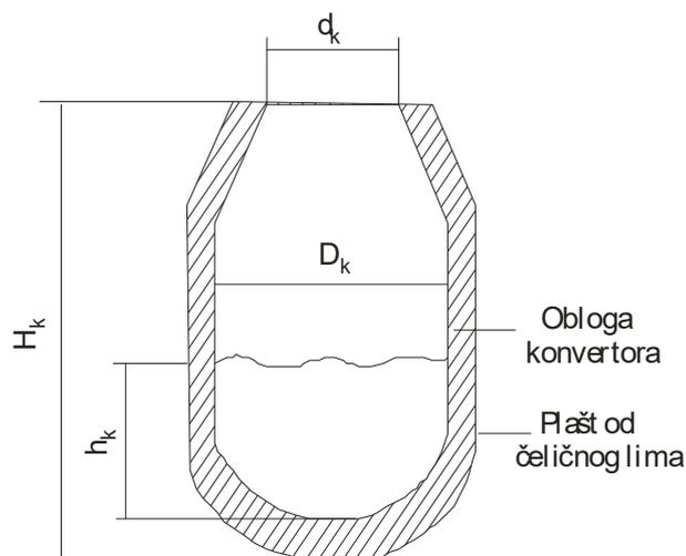
Slika 17. Shematski prikaz osnovne konstrukcije kisikovog konvertora [6]
