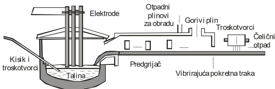
Slika 22. Shematski prikaz najbitnijih komponenti Consteel postupka [22]
