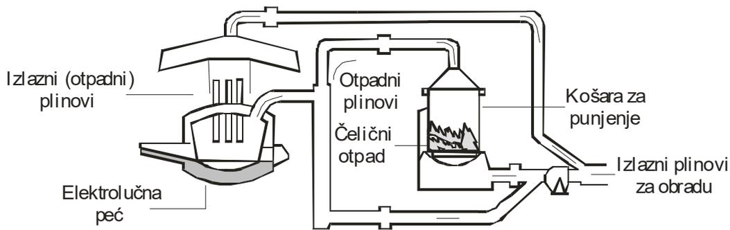
Slika 21. Shematski prikaz predgrijavanja čeličnog otpada u košari za čelični otpad [22]
