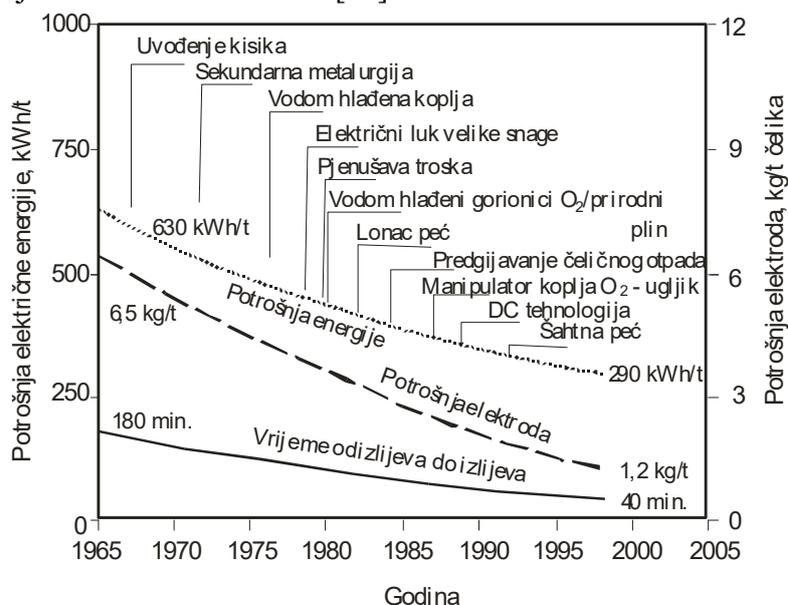
Slika 19. Tehnološki razvoj proizvodnje elektročelika [4]
