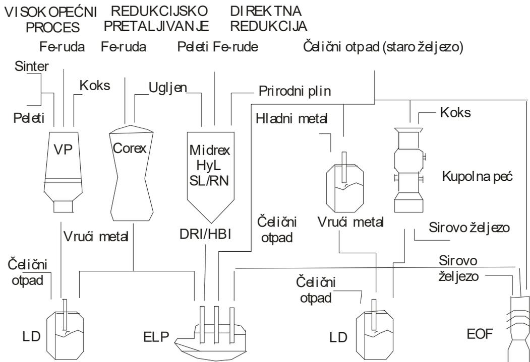
Slika 3. Shematski prikaz različitih puteva i kombinacija za proizvodnju čelika [4]
