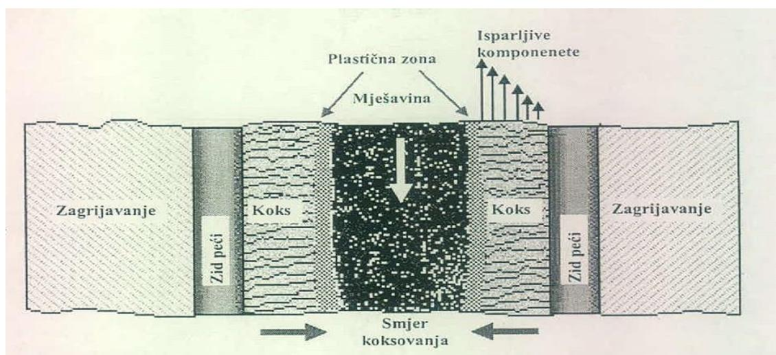
Slika 6. Prijelaz ugljene mješavine u koks za vrijeme koksiranja [20]
