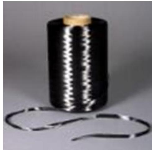
Slika 8 . Ugljična vlakna [29]
