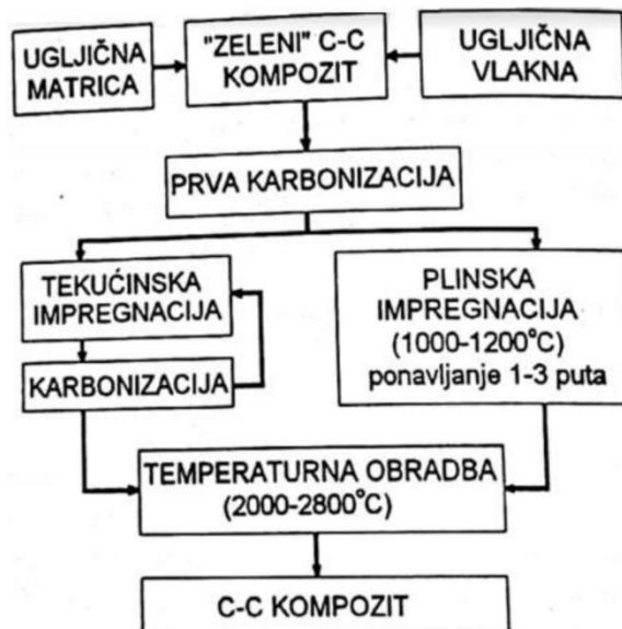
Slika 9. Shema proizvodnje C – C kompozita [9]
