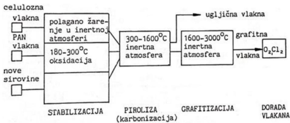
Slika 7. Faze u proizvodnji ugljičnih vlakana [9]
