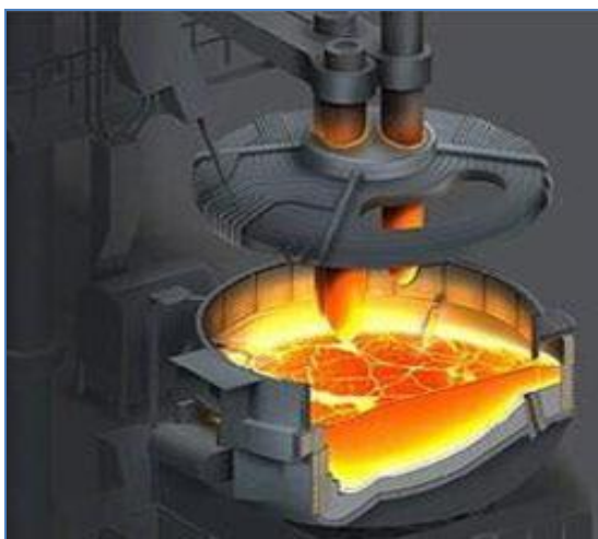
Slika 1. Troska na površini taline u elektrolučnoj peći [6]
