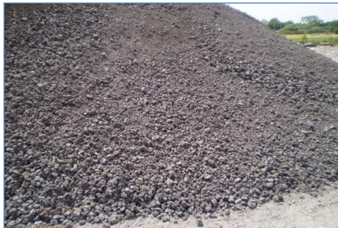
Slika 18. Pripremljen agregat od elektropečne troske iz ABS čeličane u Sisku prije rasijavanja u frakcije
