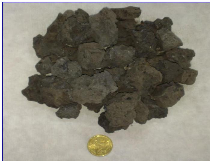
Slika 9. Izgled usitnjene elektropećne troske iz procesa proizvodnje ugljičnih čelika ABS čeličane iz Siska (T. Sofilić, 2015.)
