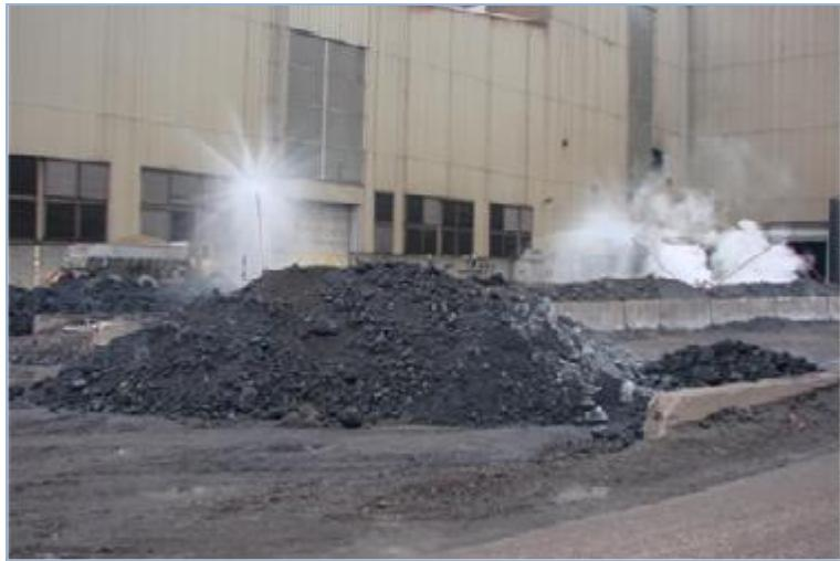
Slika 13. Brzo hlađenje troske vodom na betonskoj površini – prskanjem [27]
