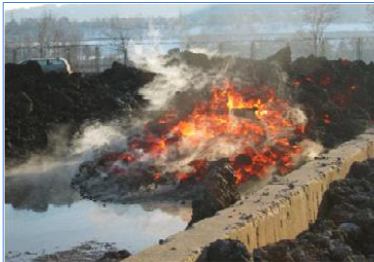
Slika 12. Brzo hlađenje troske vodom – u bazenima [27]
