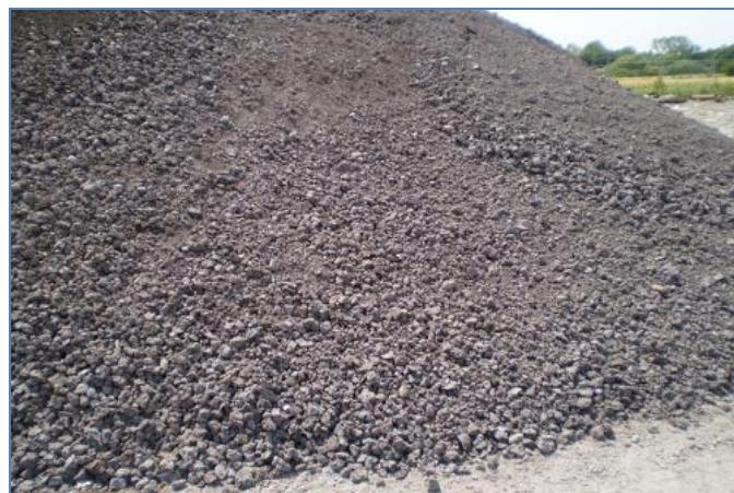
Slika 18. Pripremljen agregat od elektropećne troske iz ABS čeličane u Sisku prije rasijavanja u frakcije
