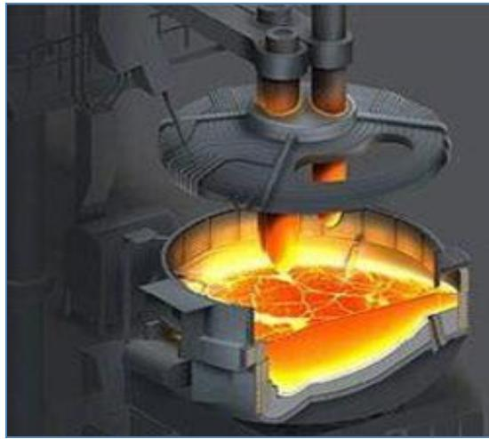
Slika 1. Troska na površini taline u elektrolučnoj peći [6]
