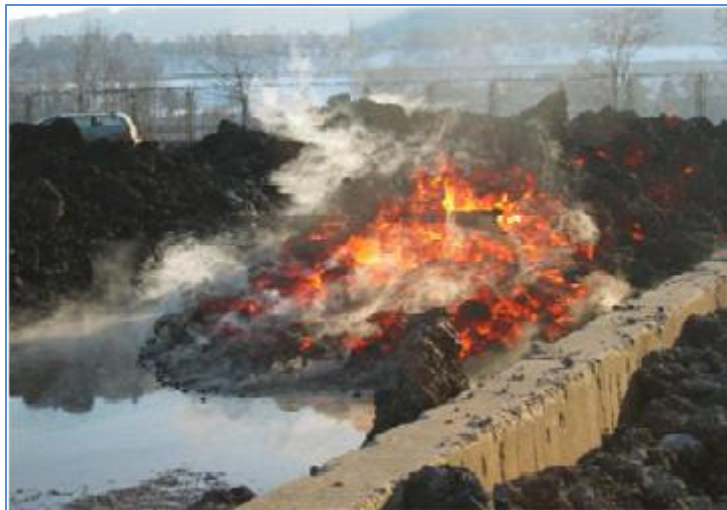
Slika 12. Brzo hlađenje troske vodom – u bazenima [27]
