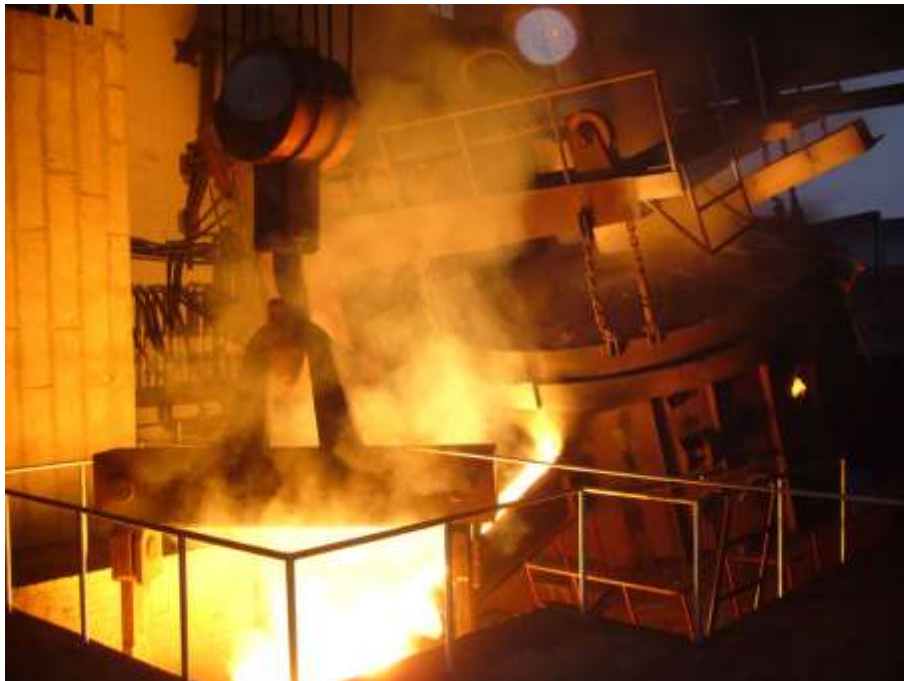
Slika 8. Izlijevanje čelika iz elektrolučne peći [28]
