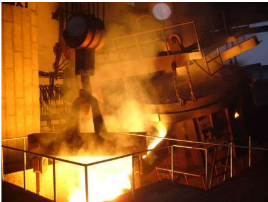
Slika 8. Izlijevanje čelika iz elektrolučne peći [28]
