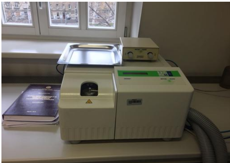
Slika 6. Diferencijalni pretražni kalorimetar Mettler-Tolledo 822e
