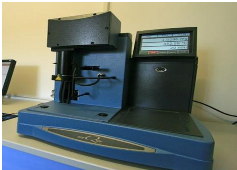
Slika 7. Termogravimetar Q500, TA Instruments
