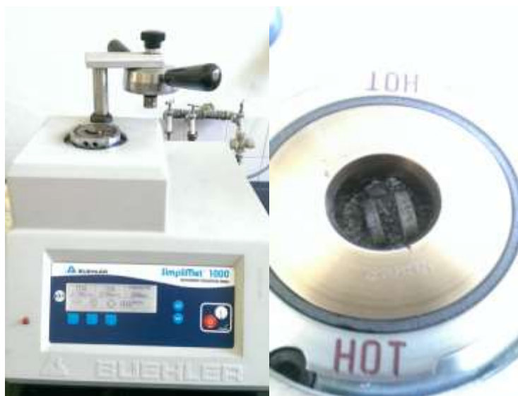
Slika 18. Ulaganje uzoraka u vodljivu masu postupkom vrućeg prešanja
