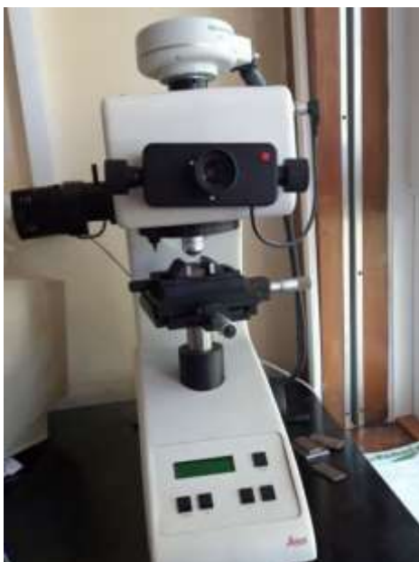
Slika 27. Uređaj za mjerenje tvrdoće metodom po Vickersu, Leica VHMT
