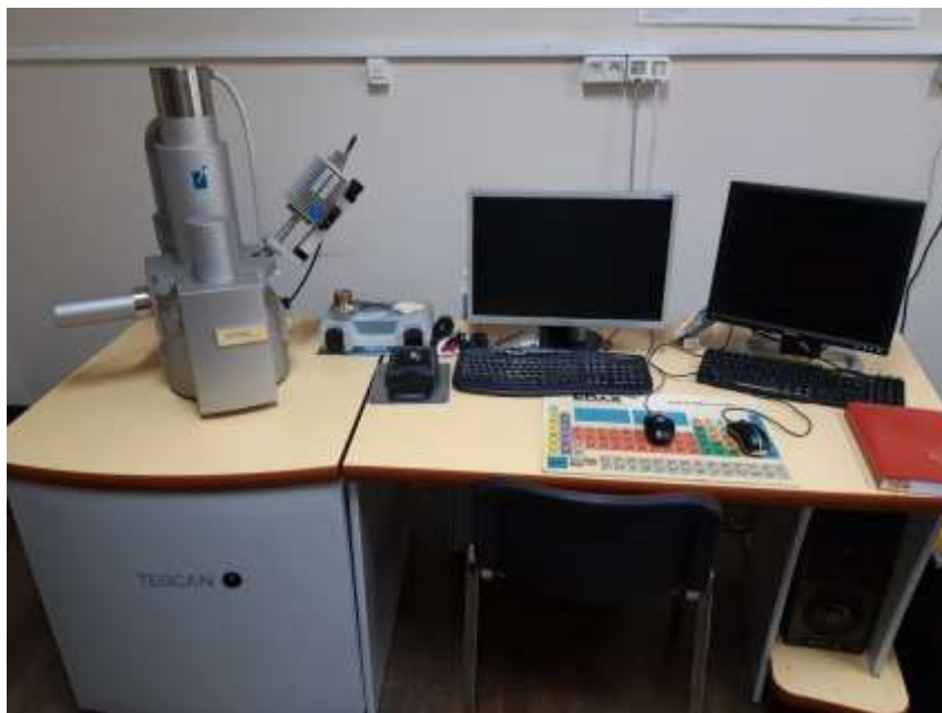
Slika 25. Scanning elektronski mikroskop Tescan Vega TS 5136 MM s EDS detektorom Bruker
