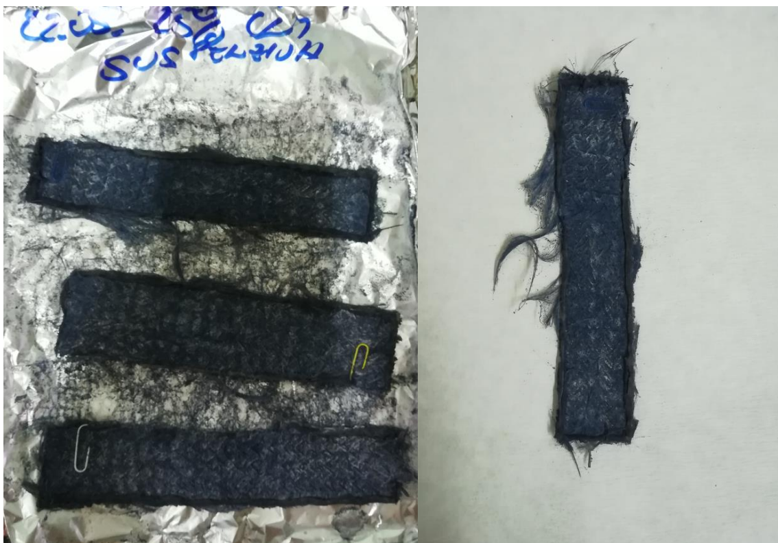
Slika 13. Prikaz mrežice sa 25 % ugljikovih nanocijevi.
