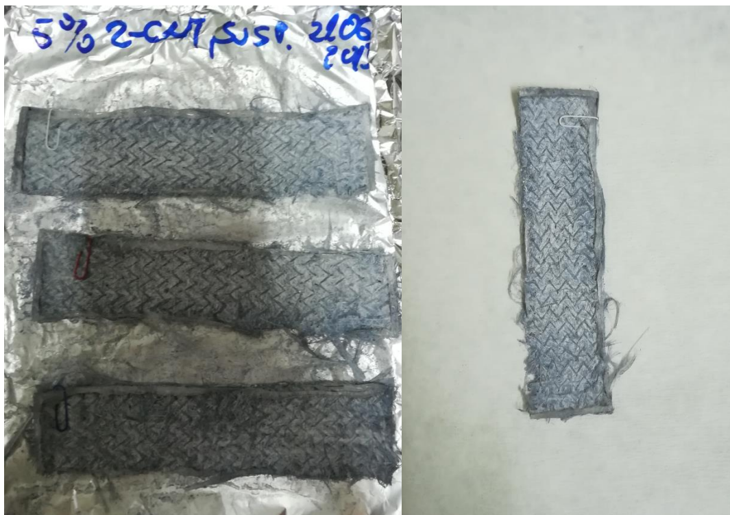
Slika 11. Prikaz mrežice sa 5 % ugljikovih nanocijevi.
