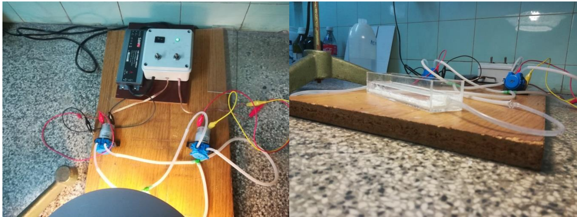
Slika 8. a) prikaz peristaltičkih pumpi, b) prikaz reaktora.
