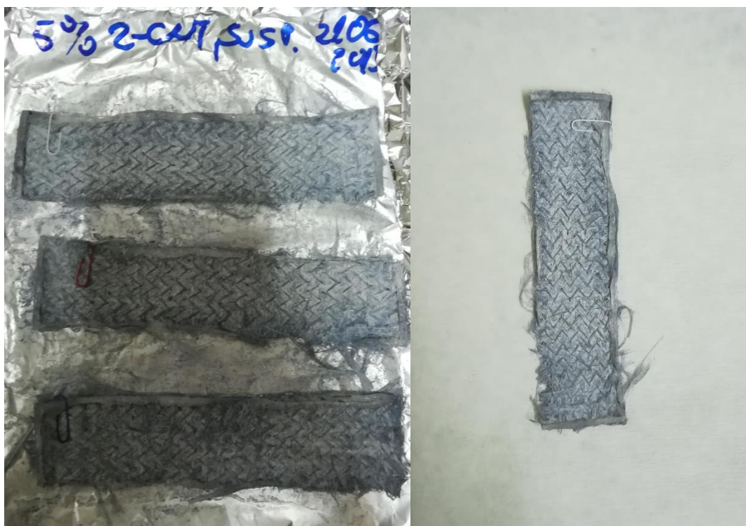
Slika 11. Prikaz mrežice sa 5 % ugljikovih nanocijevi.
