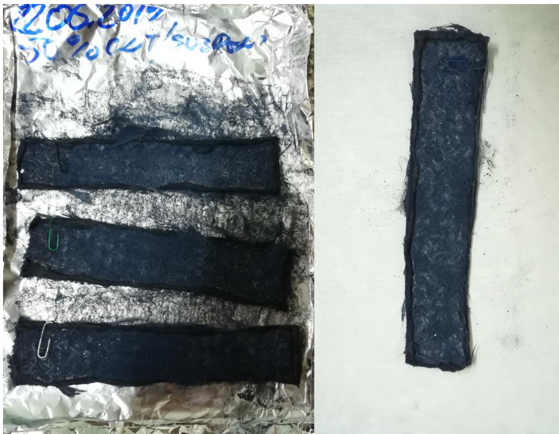
Slika 14. Prikaz mrežice s 50 % ugljikovih nanocijevi.
