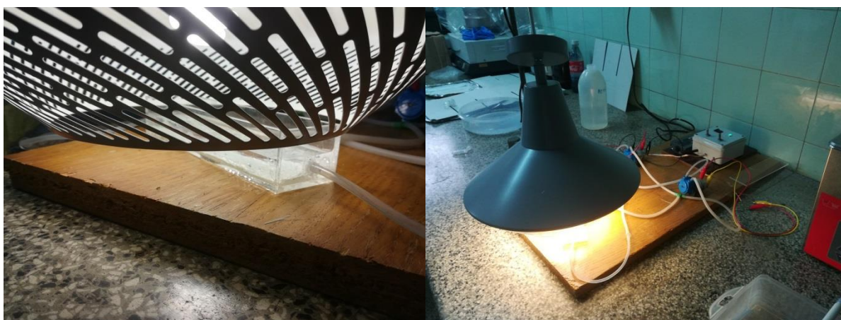
Slika 9. Prikaz izvora simuliranog sunčevog zračenja.
