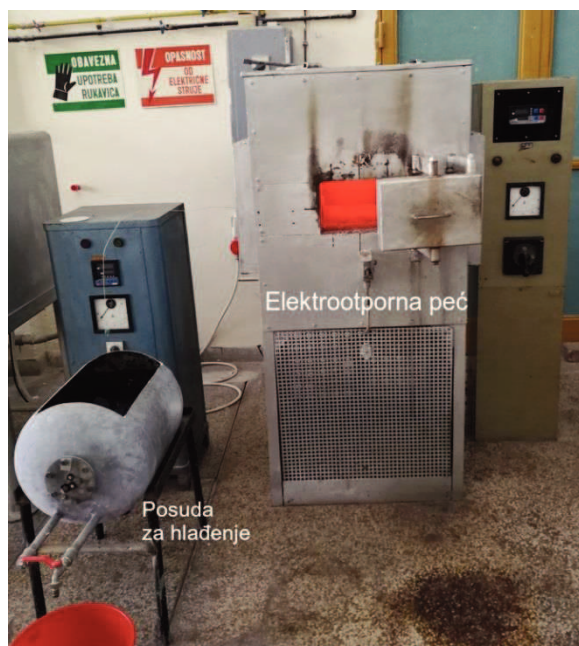
Slika 25. Fotografija elektrotopne peći i posude za hlađenje
