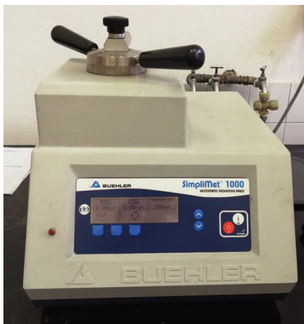
Slika 26. Fotografija uređaja Buehler Simplimet 1000 korištenog za ulaganje uzoraka u vodljivu masu
