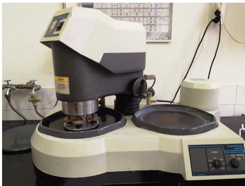
Slika 27. Fotografija uređaja Buehler „Phoenix Beta“ za brušenje i poliranje
