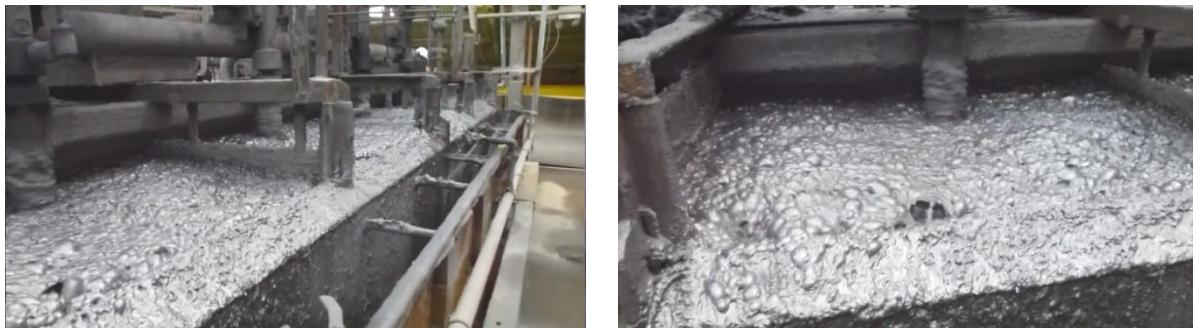
**Slika 4. Flotacija - flotacijske čelije [25]**
