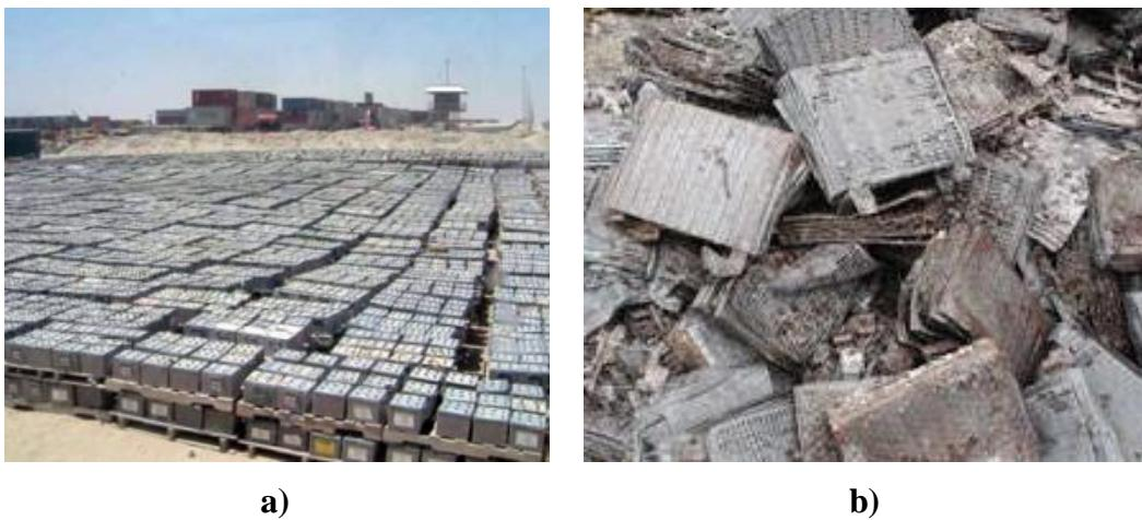
**Slika 2. Olovne baterije a) prije i b) nakon mehaničke pripreme lomljenja i uklanjanja sulfatne kiseline [20, 21]**
