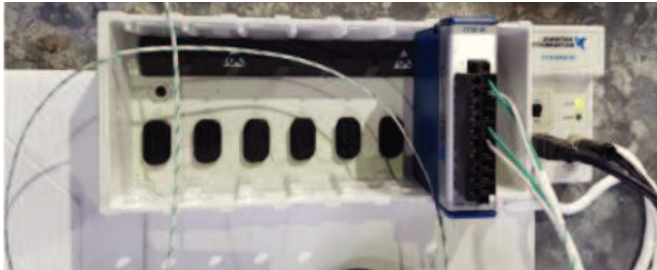
Slika 43. Uređaj za prikupljanje podataka s modulom za temperaturu
