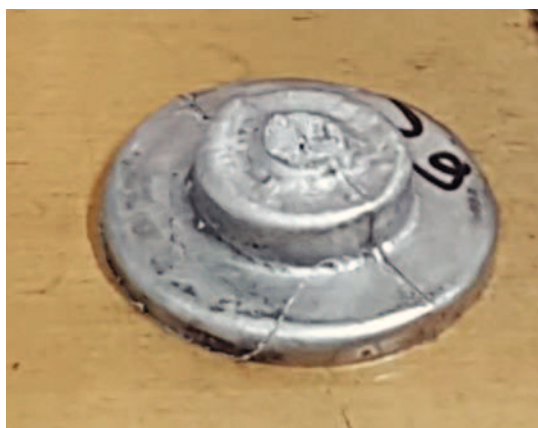
Slika 38. Uzorak za ispitivanje kemijskog sastava
