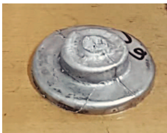
Slika 38. Uzorak za ispitivanje kemijskog sastava
