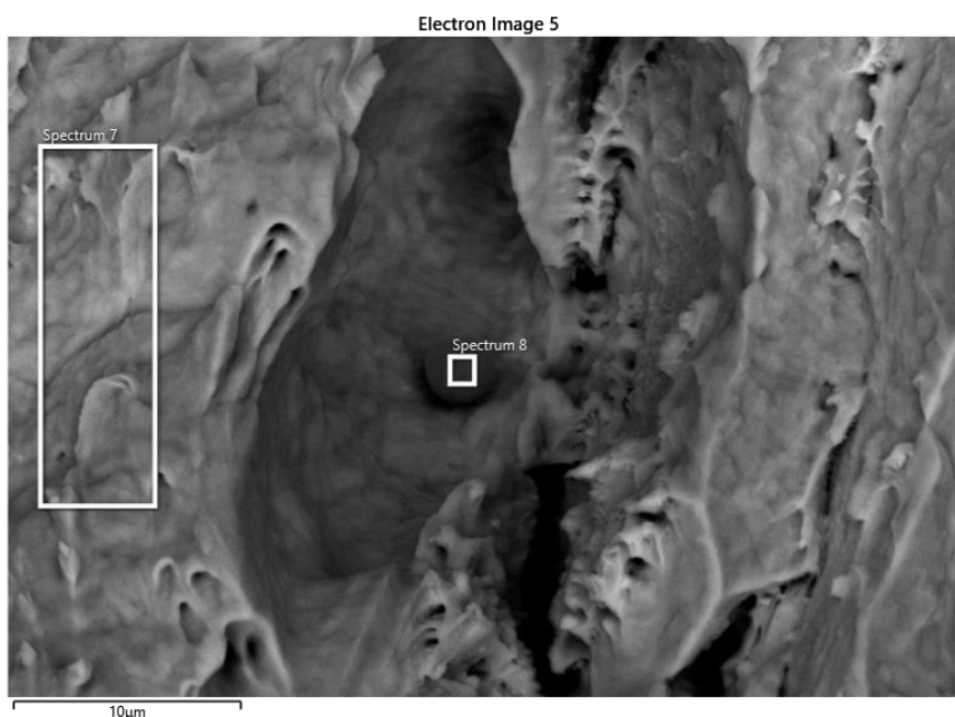
Slika 52. SEM mikrofraktografija prijelomne površine nakon ispitivanja udarne radnje loma austenitnog nehrđajućeg čelika AISI 316L nakon žarenja 850 °C/60 minuta s označenim pozicijama za EDS analizu
