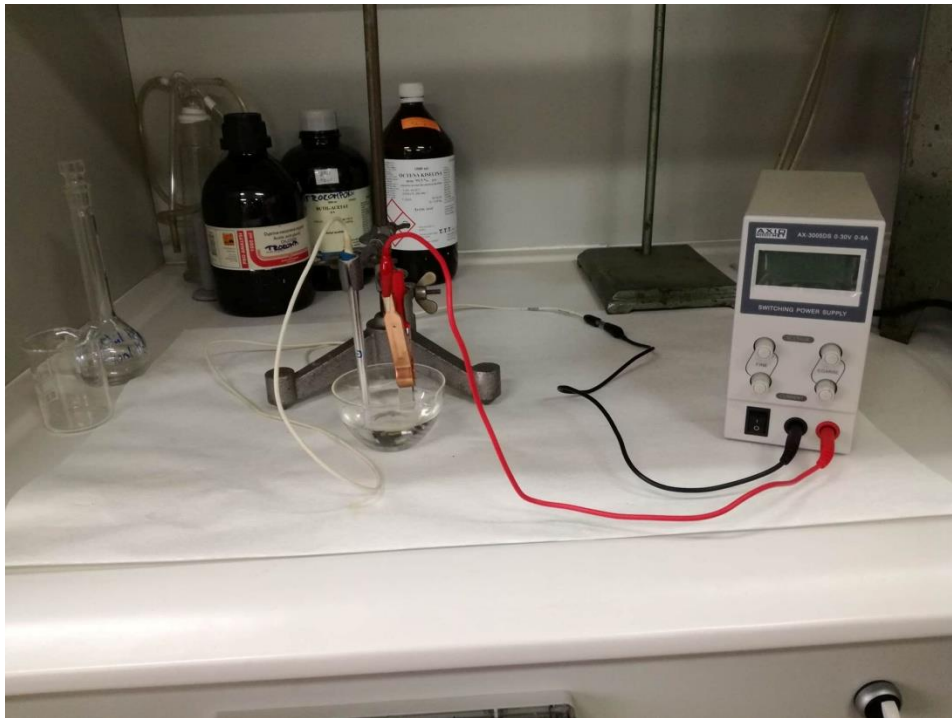
Slika 15. Fotografija aparature za elektrolitičko nagrizanje ispitanih uzoraka
