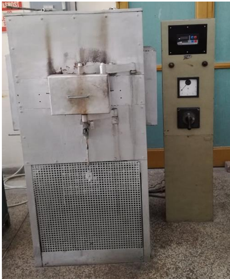
Slika 10. Fotografija elektrootporne komorne peći za žarenje
