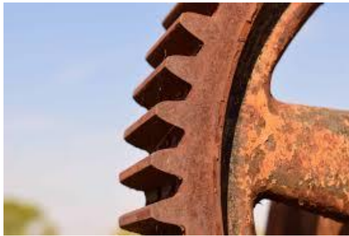
Slika 3. Opća korozija metalnog zupčanika [6]
