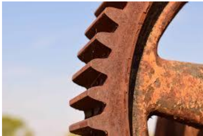
Slika 3. Opća korozija metalnog zupčanika [6]
