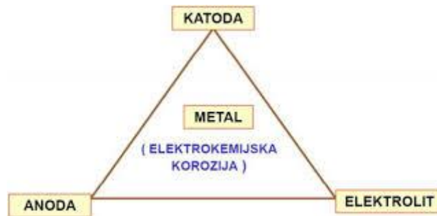
Slika 2. Uvjeti potrebni za razvijanje elektrokemijske korozije [3]
