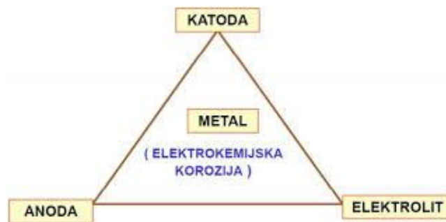
Slika 2. Uvjeti potrebni za razvijanje elektrokemijske korozije [3]
