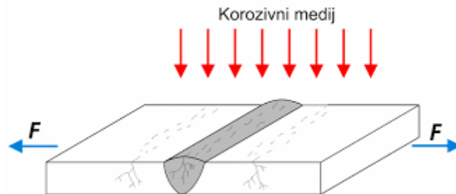
Slika 8. Čimbenici koji utječu na pojavu napetosne korozije [18]
