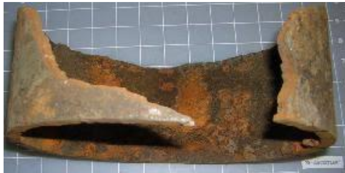
Slika 5. Grafitizacija sivog lijeva [10]
