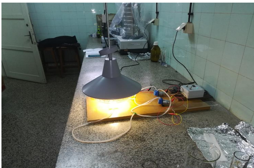
Slika 8. Fotoreaktor, UV lampa i peristaltička pumpa
