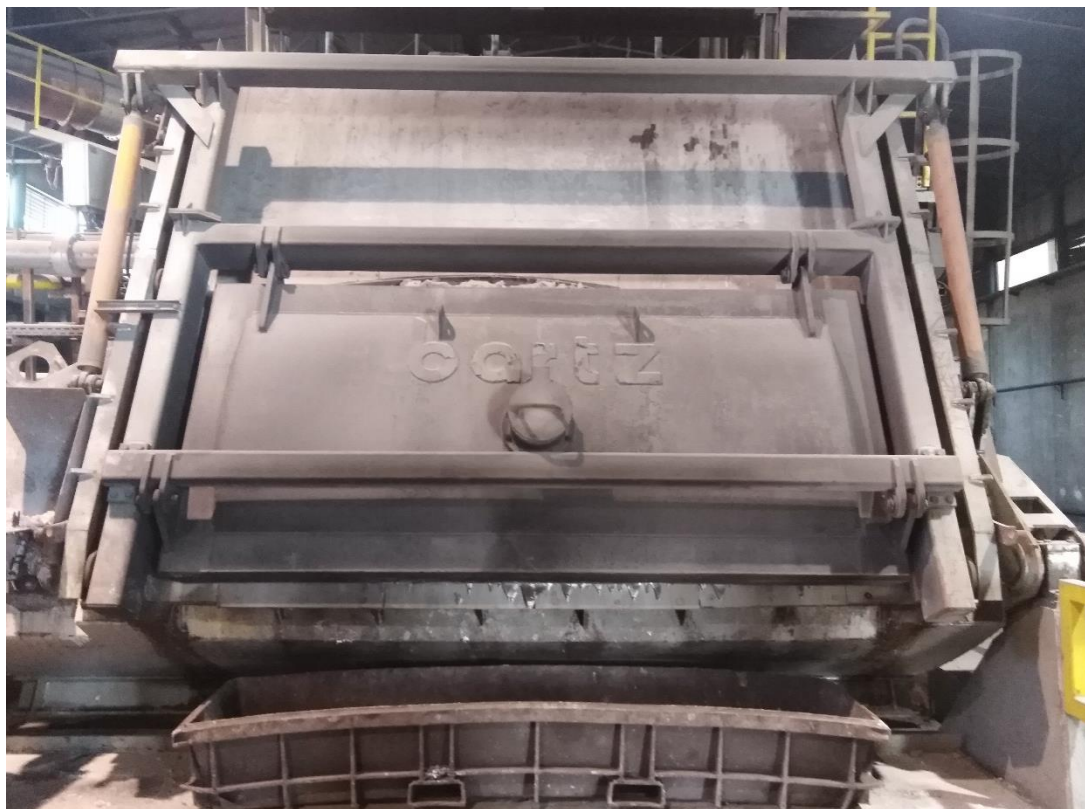
Slika 34. Peć za držanje taline u tvornici CIAL d.o.o.
