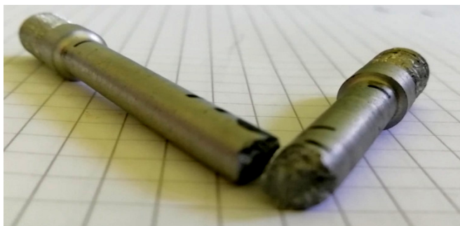
Slika 49. Uzorak za mehanička ispitivanja nakon kidanja
