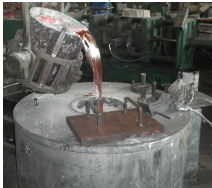
Slika 44. Peć za: a) taljenje s FDU-uređajem, b) održavanje temperature
