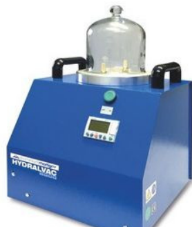
Slika 46. Uređaj za određivanje indeksa gustoće taline [59]
