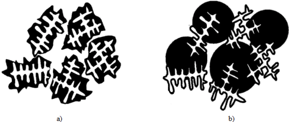
Slika 33. Shematski prikaz nastajanja eutektika prema postojećim mehanizmima: a) eutektik nastao prema mehanizmu 1) b) eutektik nastao prema mehanizmu 2) [45]
