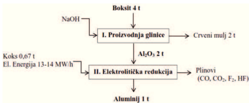
Slika 6. Shematski prikaz proizvodnje primarnog aluminija [23]
