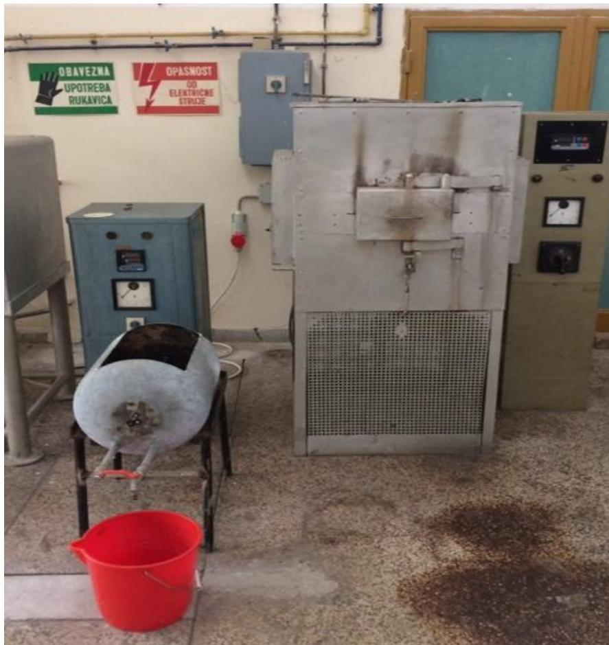
Slika 14. Fotografija peći za toplinsku obradu i posude za hlađenje uzorka
