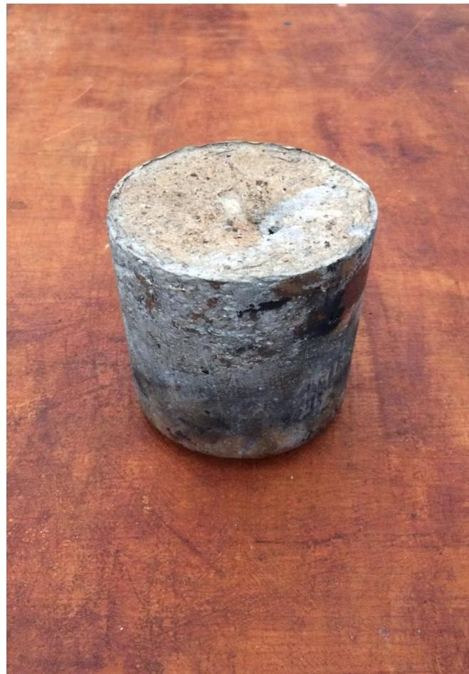
Slika 13. Fotografija ingota ispitivane CuAlMn legure
