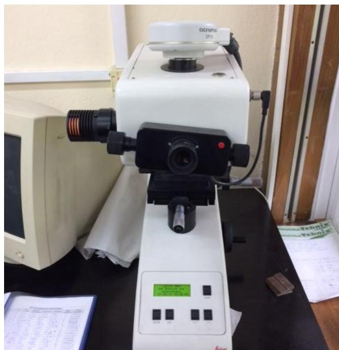
Slika 18. Fotografija tvrdomjera Leica VHMT
