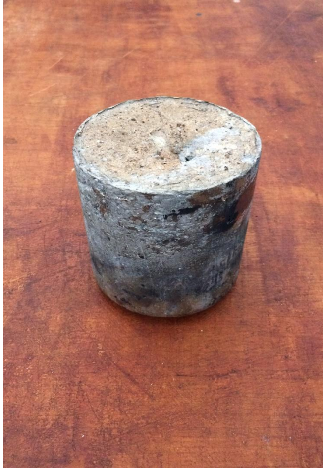
Slika 13. Fotografija ingota ispitivane CuAlMn legure
