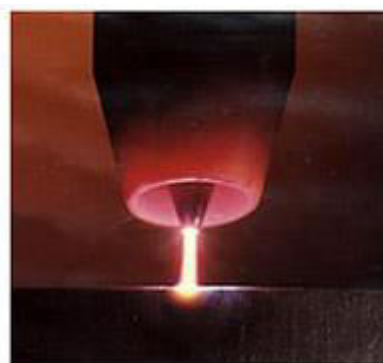
Slika 7. Zavarivanje plazmenim lukom [6]
