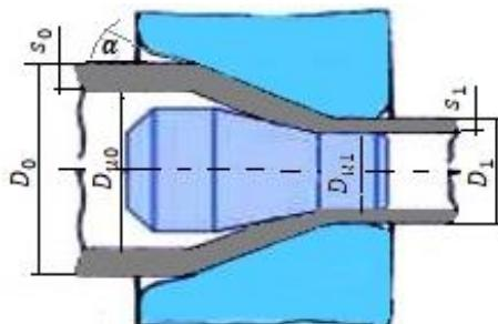
Slika 12. Izvlačenje cijevi sa plivajućim trnom [1]
