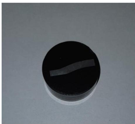
Slika 35. Uzorak spreman za metalograsku analizu
