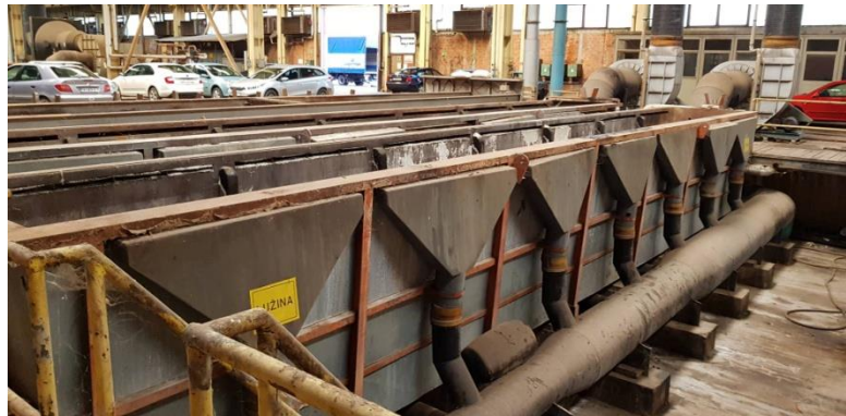
Slika 15. Kade za luženje cijevi u kiselinama
