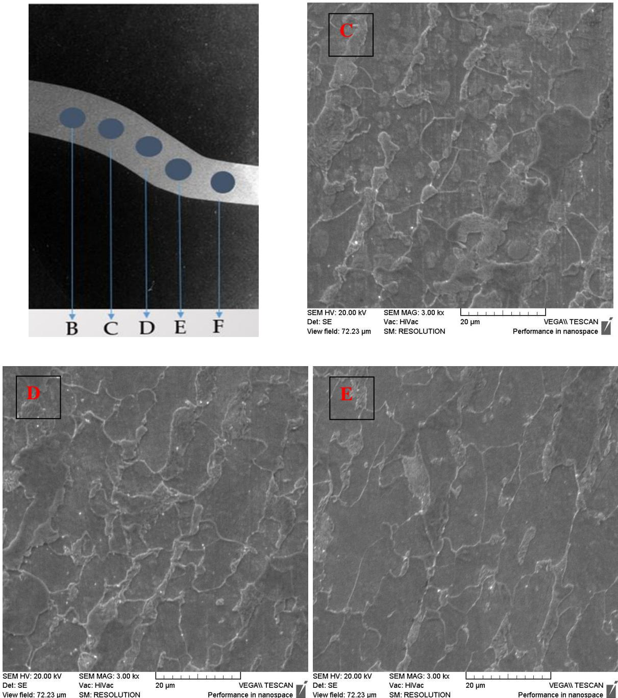
Slika 43. Promjena mikrostrukture cijevi tijekom deformacije
