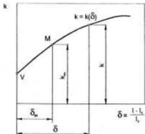
Slika 3. Krivulja očvršćivanja materijala hladnom deformacijom [4]
