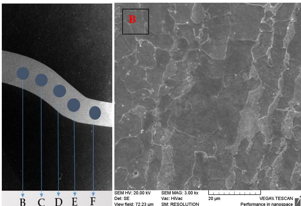
Slika 42. Mikrostruktura cijevi prije zone deformacije (točka B)
