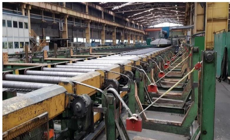
Slika 22. Cijevi nakon žarenja u peći
