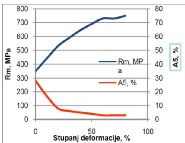
Slika 4. Mehanička svojstva niskougljičnog čelika u zavisnosti o stupnju deformacije [3]
