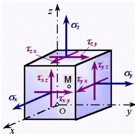
Slika 2. Prikaz normalne i tangencijalne naprezanja [4]
