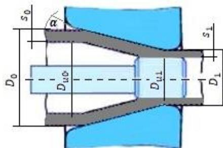
Slika 10. Izvlačenje s kratkim cilindričnim trnom [1]
