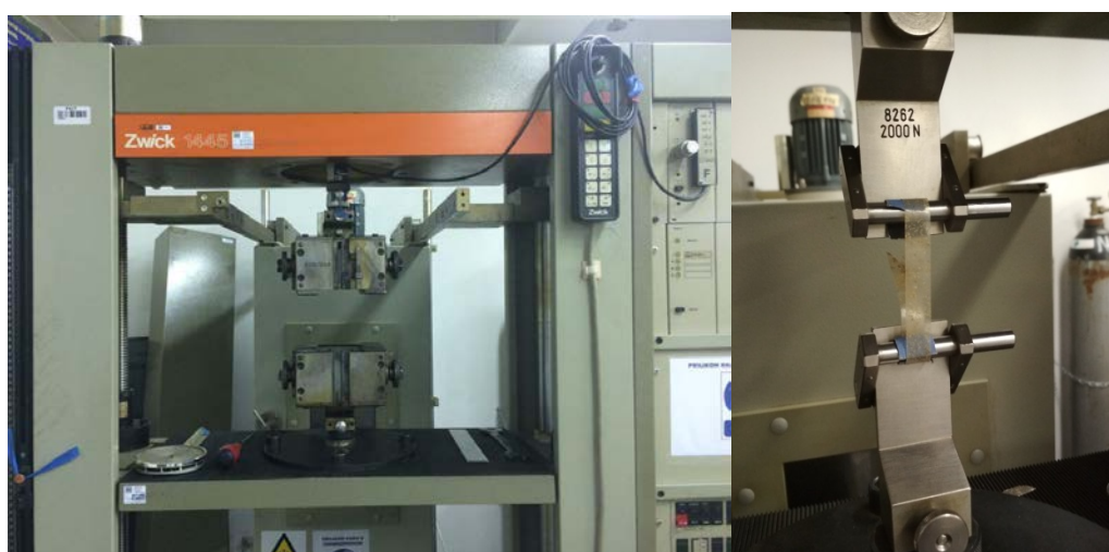
Slika 33. Mehanička kidalica Zwick 1445
