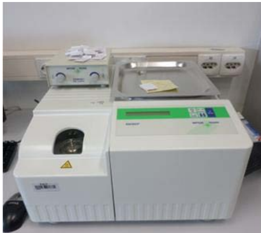
Slika 30. DSC Mettler Toledo 823 e
