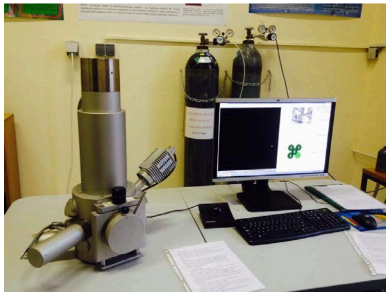
Slika 31. Elektronski pretražni mikroskop (SEM)
