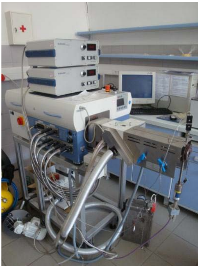
Slika 27. Laboratorijski jednopužni ekstruder Brabender 19/20 DN
