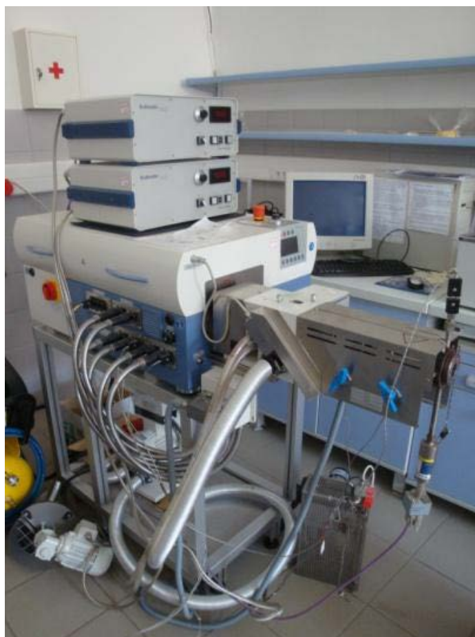
Slika 27. Laboratorijski jednopužni ekstruder Brabender 19/20 DN
