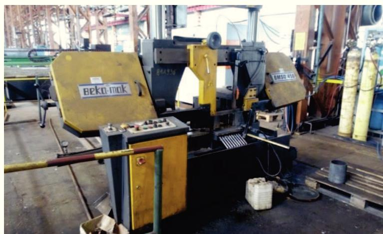
Slika 30. BEKA-MAK BMSO450 tračna pila.
