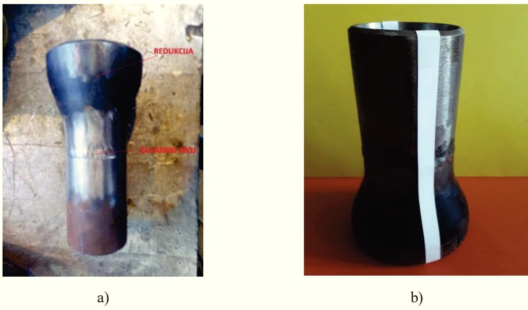
Slika 29. Sučeno zavarene cijevi s označenom: a) pozicijom zavarenog spoja, b) trakom rezanja.
