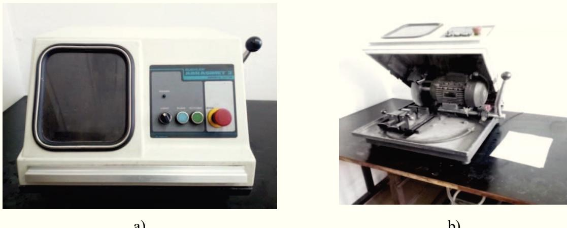
Slika 34. Rezalica "Buehler ABRASIMET 2": a) sa spuštenim poklopcem, b) s dignutim poklopcom.
