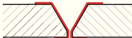
Slika 26. Označeni dijelovi sučeonog spoja koji moraju biti čisti [27].
