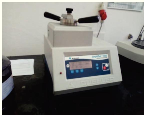
Slika 36. Uređaj za vruće izostatsko prešanje; "BUEHLER SimpliMet 1000".
