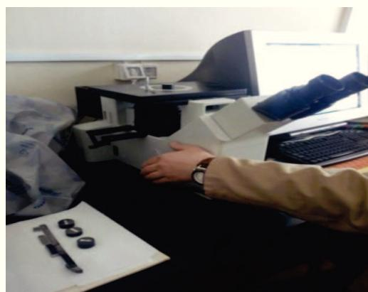
Slika 40. Invertni metalografski mikroskop Olympus GX51 s digitalnom kamerom DP70.
