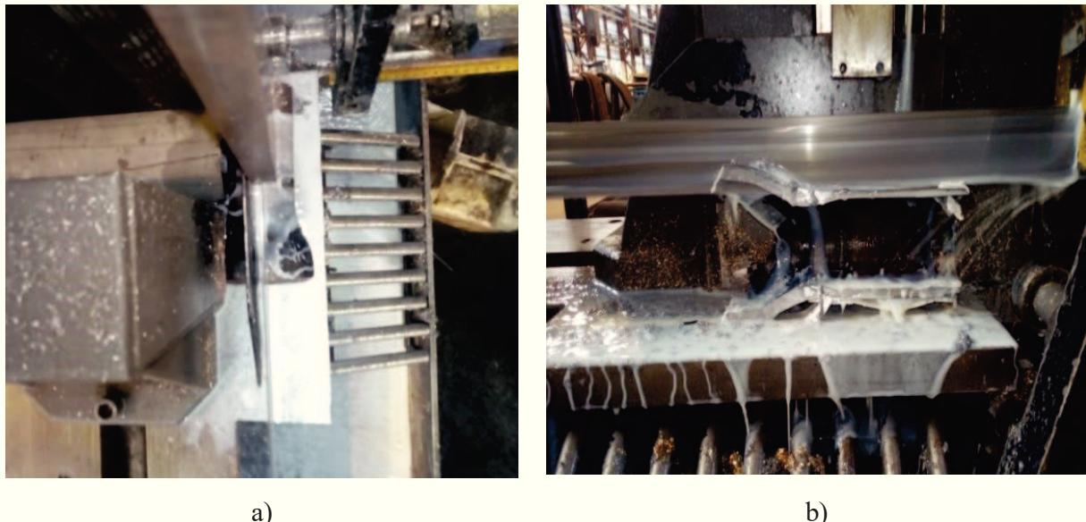
Slika 32. Rezanje na tračnoj pili: a) vertikalni pogled na postupak rezanja, b) postupak rezanja.
