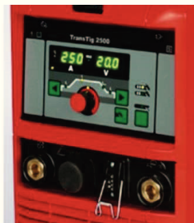
Slika 8. Napon i struja zavarivanja prikazani na aparatu za zavarivanje [14].
