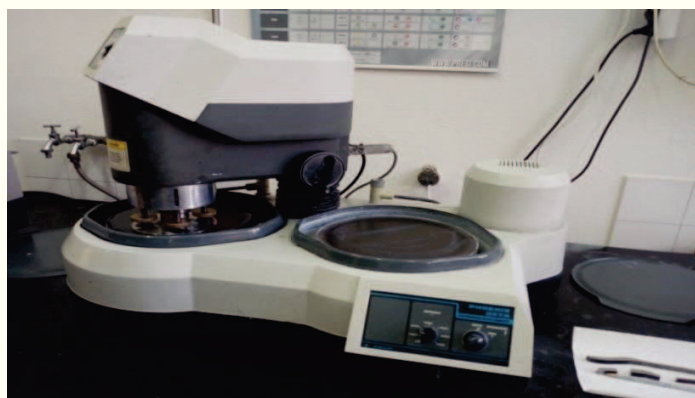
Slika 37. Uređaj za brušenje i poliranje "BUEHLER Phoenix Beta".
