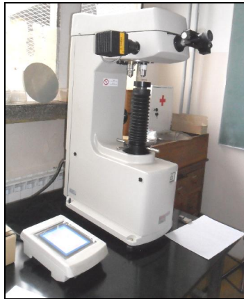
Slika 3.5. Ispitivanje tvrdoće metodom prema Vickersu
